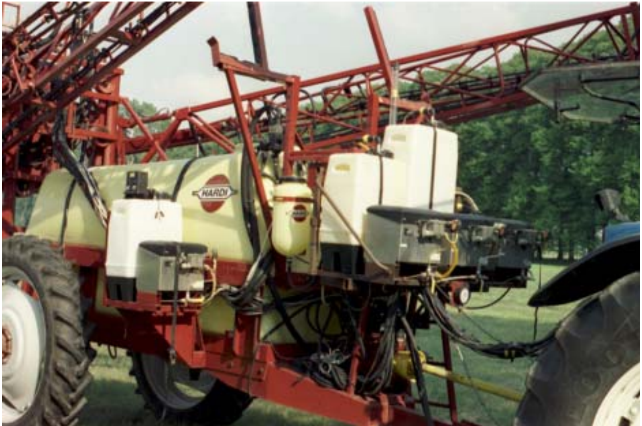
Den undersøgte Hardy Commander sprøjte monteret med Raven system med fem jektionsbeholdere.
