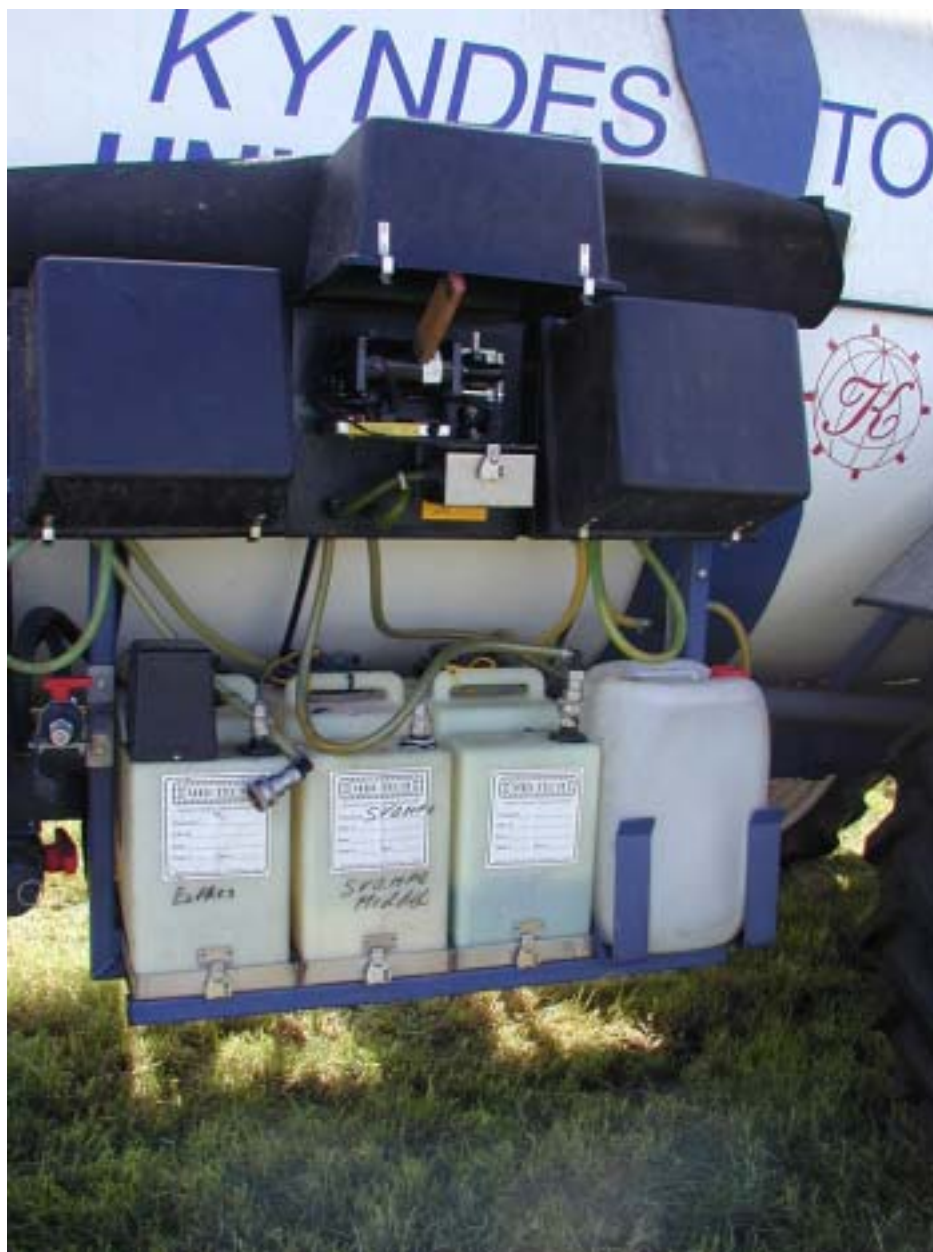
LH Multiflow system med tre injektionsbeholdere.
