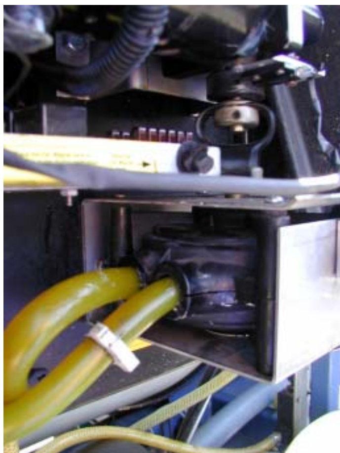
Peristaltisk (slangepumpe) på LH Multiflow
