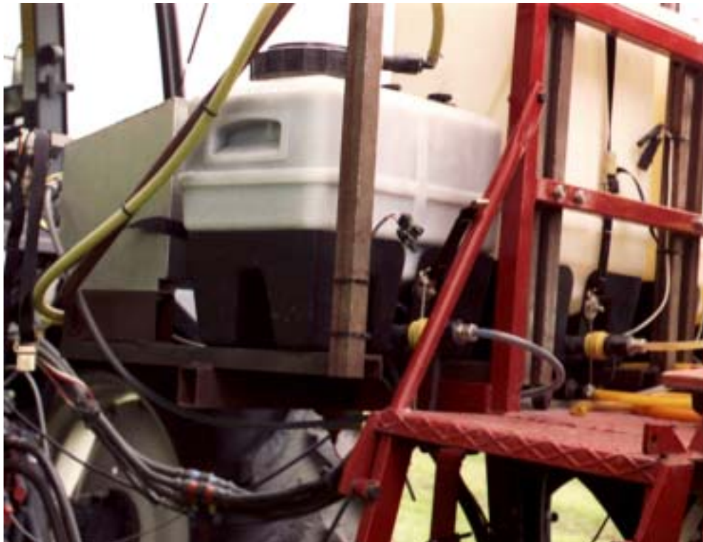
Raven injektionsmodul. Pumpen sidder i kassen foran injektionsbeholderen.
