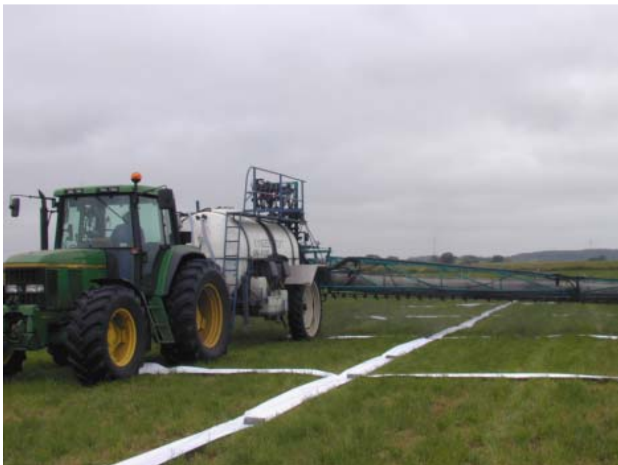
Den undersøgte Kyndestoft Uniflyg sprøjte med LH Multiflow med tre injektionsheholdere
