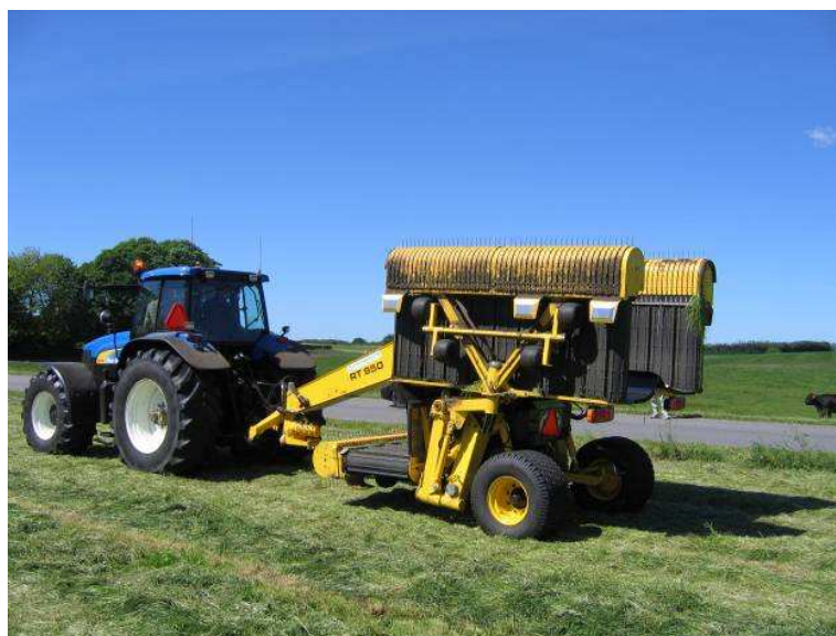
Figur 1. Pickup rive i transportstilling. Bemærk den relativt lave højde af riven – 3 meter.
