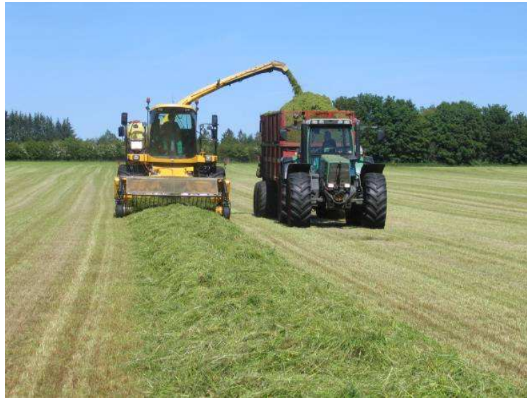
Figur 9. Finsnitning af græs. Skår revet sammen af pickup rive. Bemærk at pickuppen på finsnitteren lige netop kan gabe over skåret.
