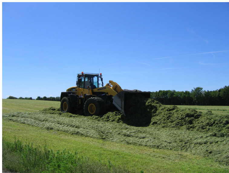
Figur 10. Sammenkøring af snittet græs med gummiged i markstak.
