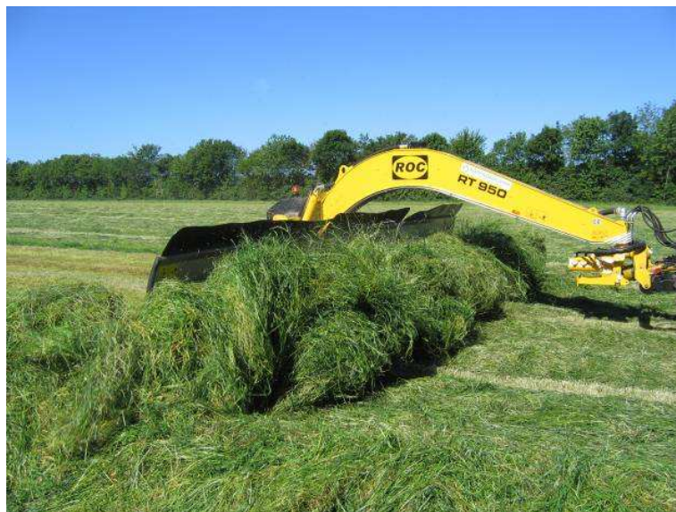
Figur 2. Pickup rive i arbejde. Bemærk: stor græsmængde.
