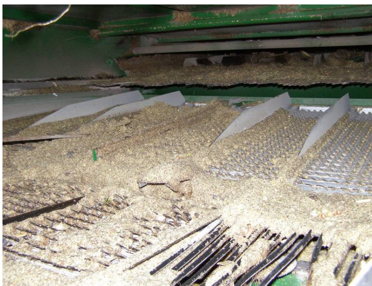
Figur 5. Det største problem ved høst af meget våd majs var lukning af soldene med vådt smuld.
