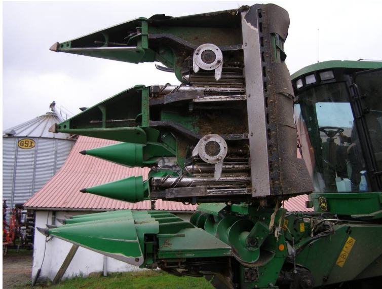
Figur 10. Kemper har også roterende knive under skærebordet.
