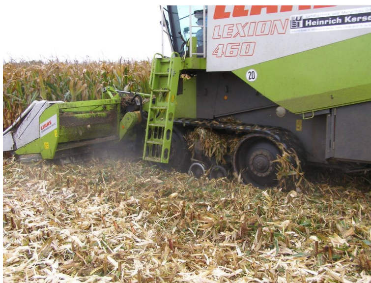
Figur 2. Ofte er forholdene så våde, at bælter på mejetærskeren kan være nødvendige.
