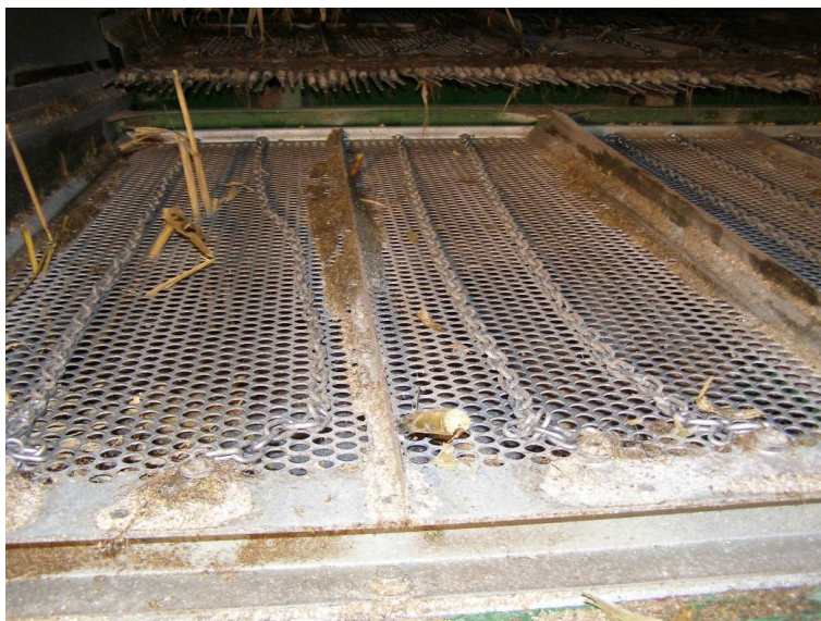
Figur 17. Hulsold med slappe kæder og \varnothing 16 mm huller giver en meget fin færdigvare.
