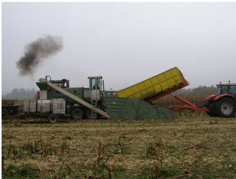
Figur 29. Stor dieseldrevet hammermølle med en kapacitet på 100 tons i timen
