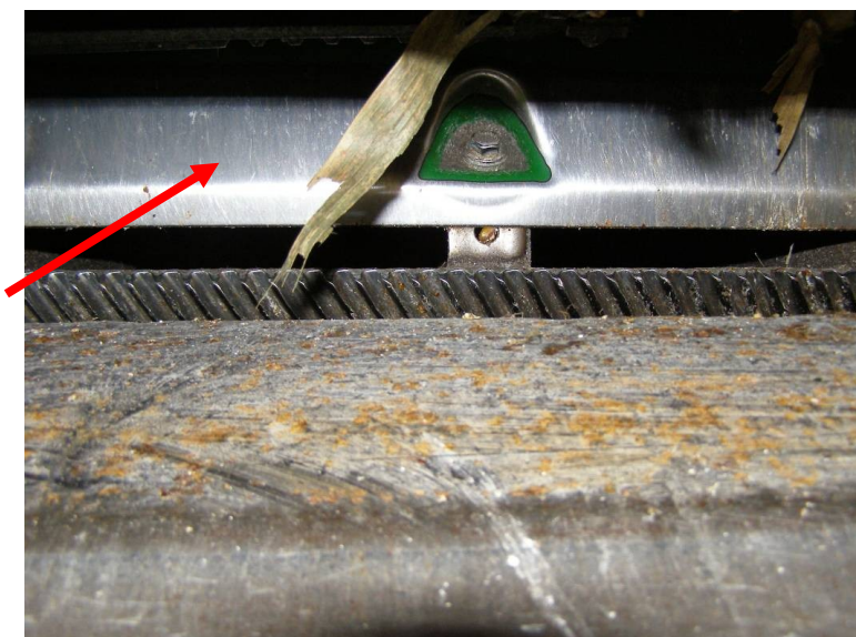
Figur 12. Her er der monteret dækplader mellem slaglerne på cylinderen.
