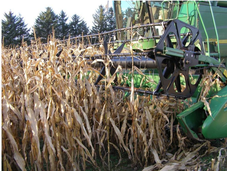
Figur 6. Det var ikke noget problem at høste majsen med et almindeligt skærebord, men der må regnes med større spild af kolber og mere snavs på soldene end ved brug af plukkebord.
