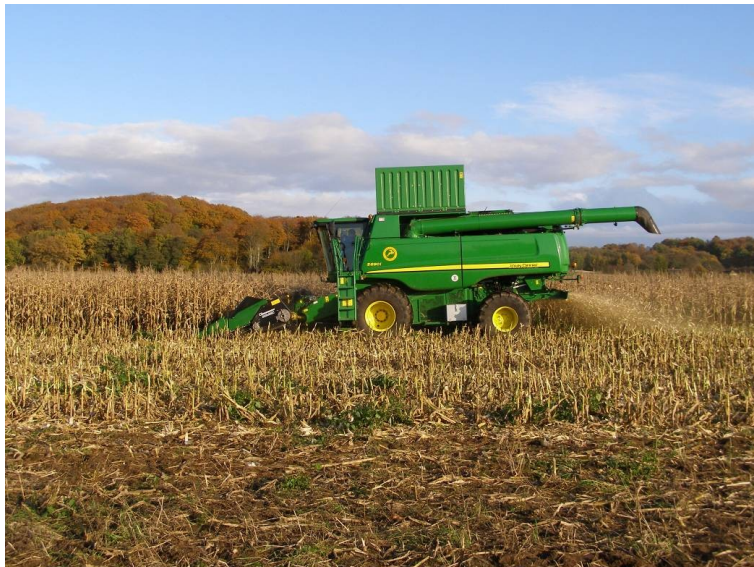
Figur 11. Her er der ikke anvendt en roterende kniv til at pudse stubben, som derfor er mere uensartet.
