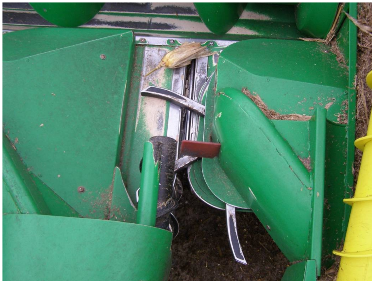
Figur 9. Kemper anvender ikke kæder, men roterende medbringere.
