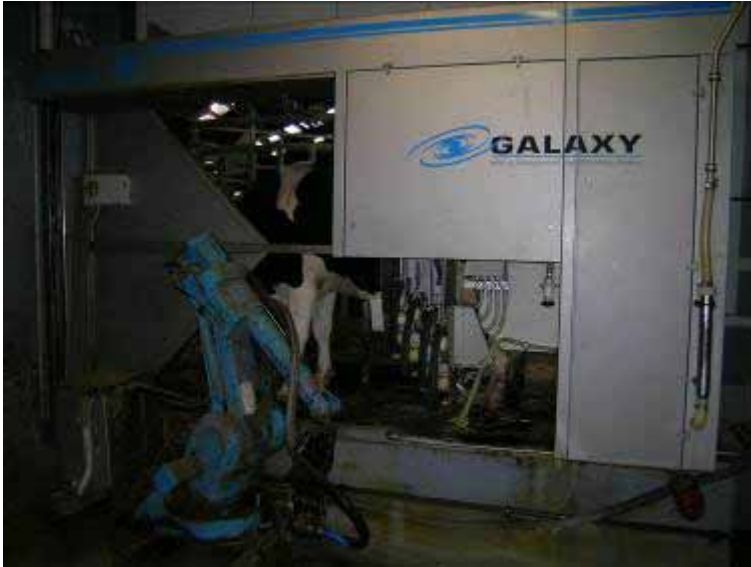
Figur 5.1. SAC Galaxy automatisk kraftfoderautomat i AMS. Foderet tildeles, når koen med transponder aktiverer en sensor ved truget.
