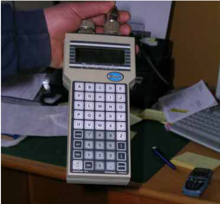
Figur 9.4. Programmering og styring foregår via en terminal. Brugervenligheden er tilfredsstillende, og brugeren kan selv foretage alle ændringer og kalibreringer.
