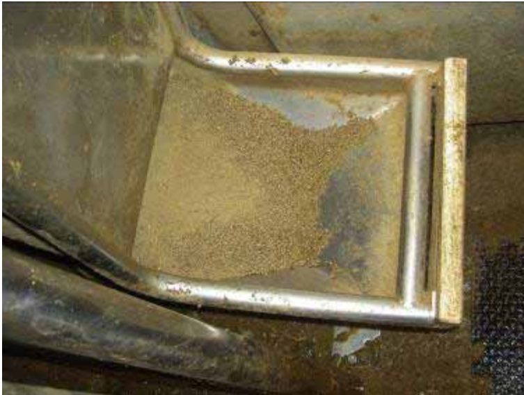
Figur 4.2. Trugets fremstilles af rustfrit stål. Desværre er udformningen iflg. brugeren ikke optimal for køerne.
