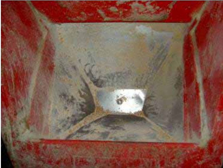
Figur 7.2. Trugets er i rustfrit stål, men har kanter i bunden, hvor foderrester ophober sig. Dette medfører øget rengøring og nedsat hygiejne. Generelt er automatens udformning tilfredsstillende. De høje sider nedsætter foderspild til siderne.
