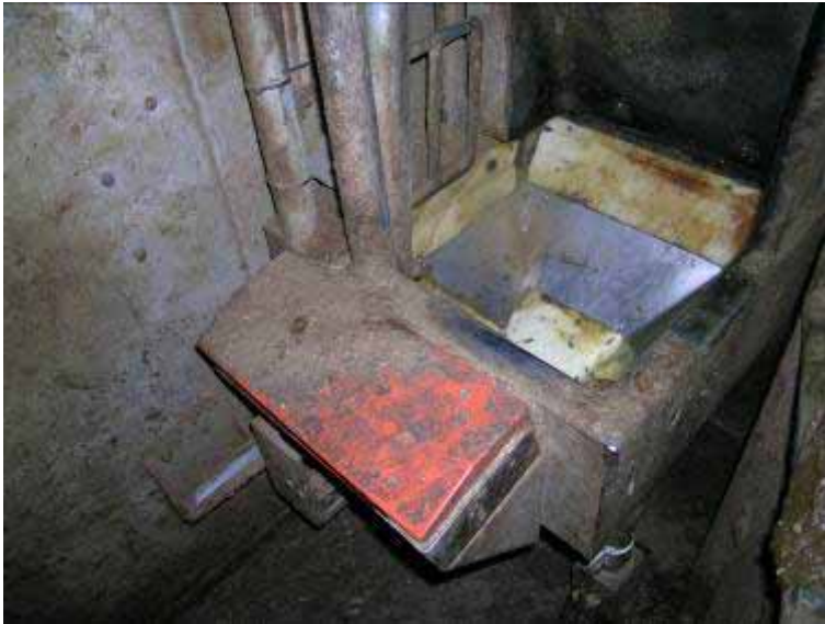
Figur 6.2. Truget er i plast med rustfrit stål. Transponderdelen er velfungerende. Desværre er der mange kanter på truget, hvor foderet kan sætte sig. Dette nedsætter hygiejnen og rengøringsvenligheden.
