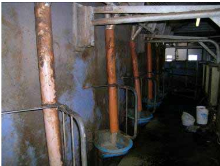
Figur 9.1. Strangkos automatiske kraftfoderautomater i malkestalden. Foderet tildeles når koen med transponder passerer en antenne ved indgangen til malkestalden.
