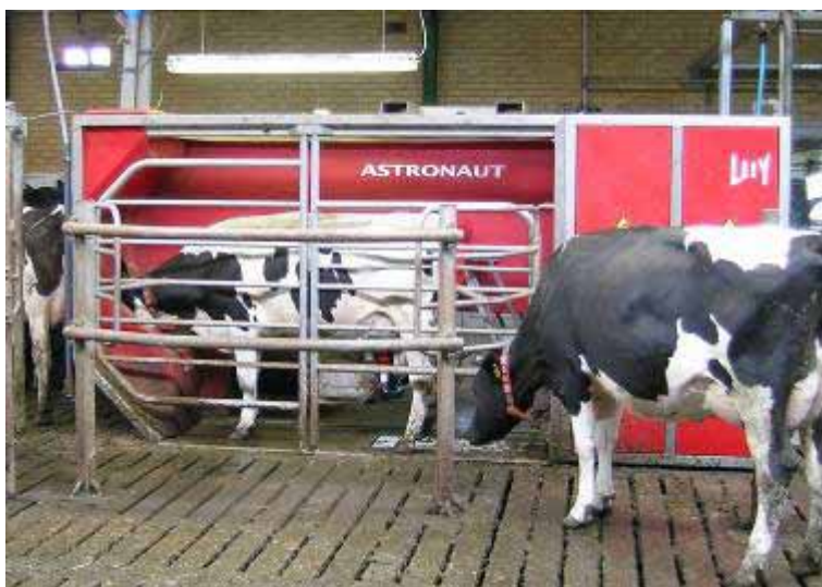
Figur 7.1. Lely automatisk kraftfoderautomat i AMS. Transponderen om koens hals aktiverer udfodringen.
