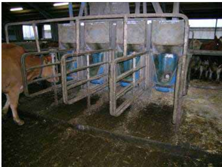
Figur 11.1. DeLavals automatiske kraftfoderanlæg til fodring af køerne i stalden. Udfodringen foregår vha. transponder, som er monteret om koens hals.
