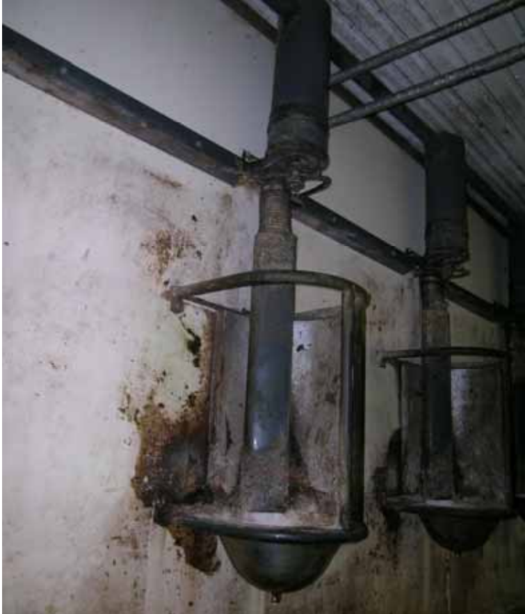
Figur 17.1. Westfalia tilbyder et manuelt kraftfoderanlæg til fodring af køerne under malkning. Udfodringen foregår vha. ryk i håndtag fra malkegraven (snoretræk).
