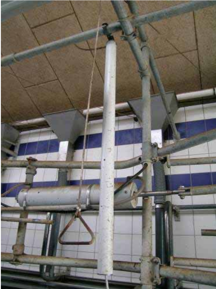
Figur 15.1. Foderet udfodres ved at trække i håndtaget, som er forbundet til automaten.
