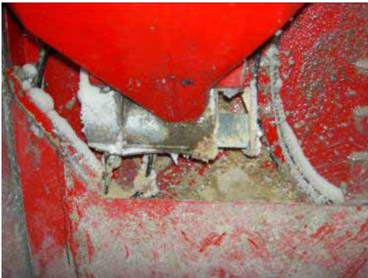
Figur 7.3. Udfodringsmekanikken er følsom over for fugt og støv. Den skal derfor renses ugentligt. Der fodres med valset korn og sojaskrå, som støver meget.
