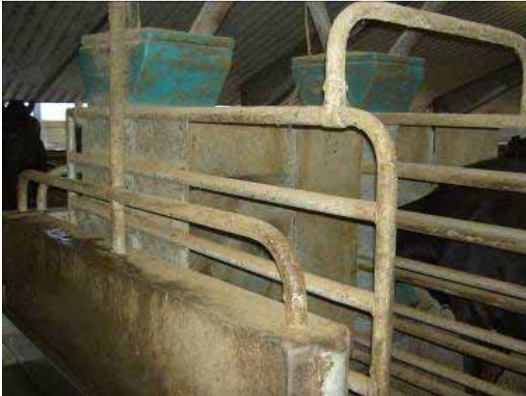
Figur 12.1. Lely tilbyder et automatisk kraftfoderanlæg til fodring af køerne i stalden. Udfodringen foregår vha. transponder, som er monteret om koens hals.
