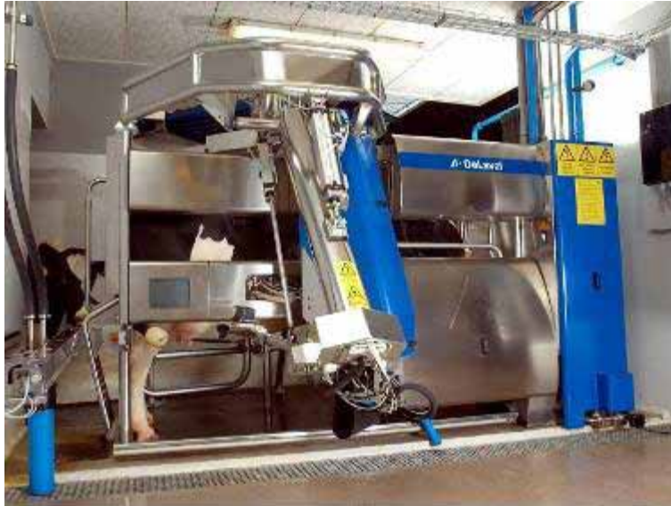
Figur 4.1. DeLaval automatisk kraftfoderautomat i AMS. Foderet tildeles, når koens transponder aktiverer en sensor ved foderkrybbe.
