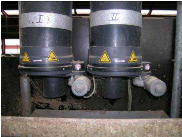
Figur 13.4. Kraftfoderet blev doseret i disse beholdere. Udfodringen fungerer godt, og præcisionen er tilfredsstillende. Med to beholdere er det muligt at fodre to typer foder uafhængigt af hinanden.
