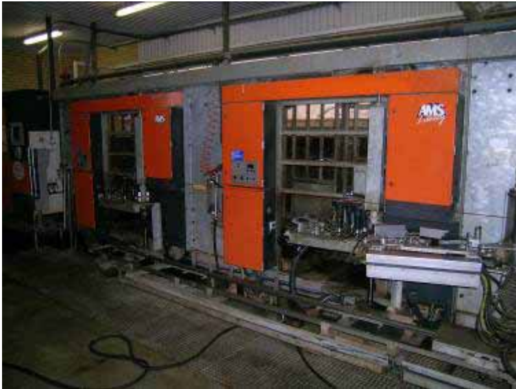
Figur 6.1. Gascoigne Melottes automatiske kraftfoderautomat i AMS. Foderet tildeles, når koen med transponder kommer hen til truget.
