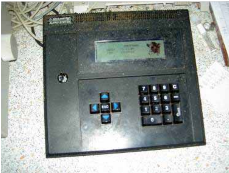
Figur 10.4. Betjeningen sker via et kontrolpanel, som er koblet på computeren. Betjeningen er simpel, og brugeren kan selv kalibrere systemet.
