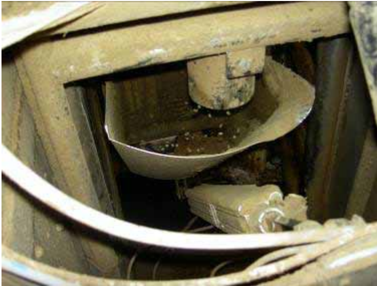
Figur 4.4. Udfodringsrøret er stort i diameter og pakker ikke til. Mekanikken er ikke tilstrækkelig afskærmet for foderrøret og samler derfor meget skidt og støv, hvilket nedsætter hygiejnen.
