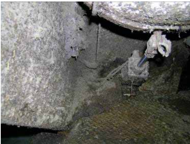
Figur 5.4. Mekanikken og pladsen under truget er ikke tilstrækkelig afskærmet. Her samler sig derfor meget skidt og foderrester, hvilket nedsætter hygiejnen og kræver hyppig rengøring.
