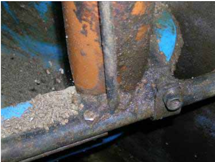
Figur 9.3. Overgangen mellem foderrør og trug er meget dårlig konstrueret. Her ophobes store mængder foder og hygiejnen er dårlig.
