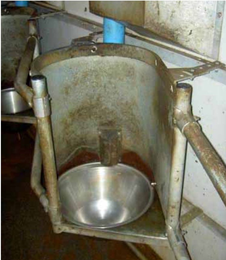
Figur 8.4. Trugets sider var beskidt og angrebet af rust. Materiale og overflade kan forbedres.
