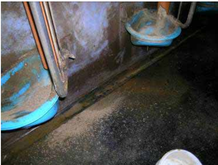
Figur 9.5. En knækket kant på foderrøret medfører, at meget af foderet falder ved siden af truget. Foderrørene bør være i stål og ikke PVC, som knækker i kanten. Brugeren har selv skiftet foderrør, da de oprindelige i stål havde for lille diameter.
