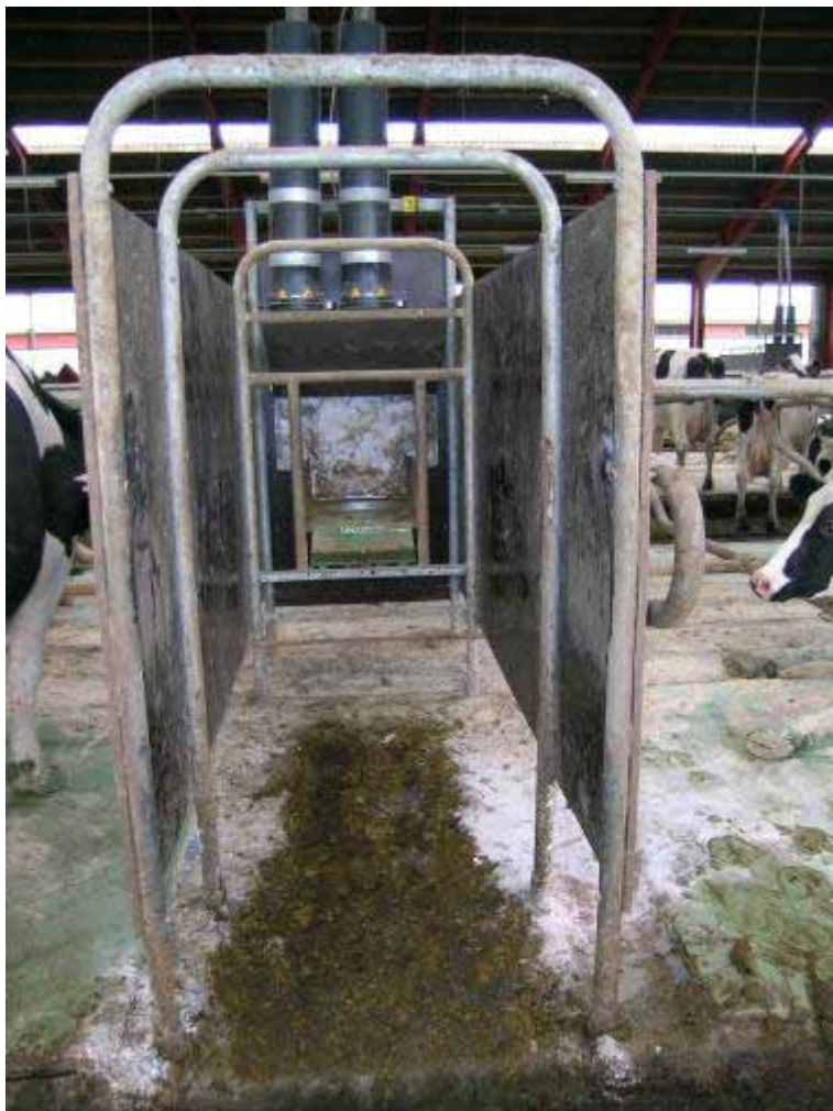
Figur 13.2. Automaten er med 75 cm den bredeste i Westfalias program. Der er alligevel kraftige slidmærker på de indvendige stålbojler. Danske anbefalinger lyder på 85 cm, hvilket bør overholdes, for at koen har tilstrækkelig plads. Der er ingen problemer med at få køerne ind i boksene her trods den smalle bredde.
