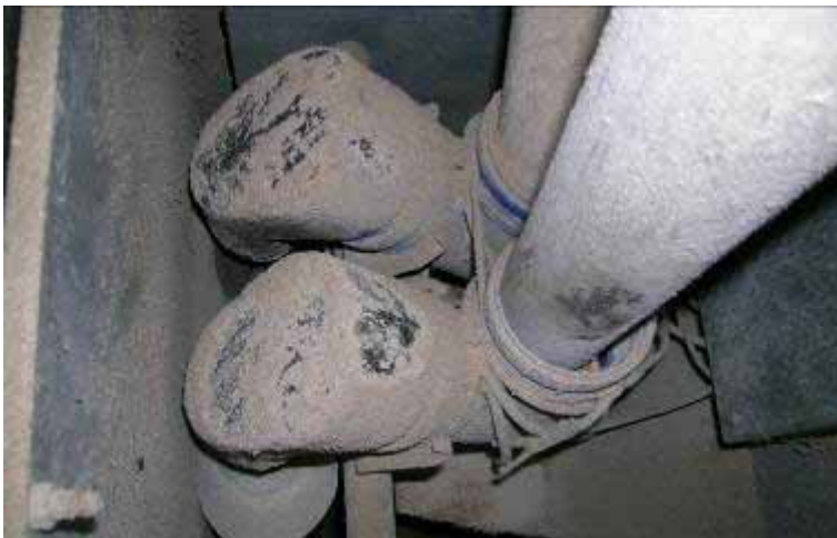
Figur 11.4. Automaten er meget åben. Her set ovenfra og ned til udfodringsenhederne. Et mere lukket system ville fremme rengøringsvenligheden og hygiejnen.
