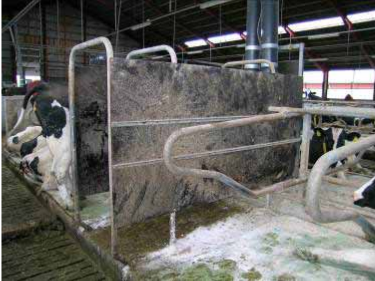
Figur 13.1. Westfalias automatiske kraftfoderanlæg til fodring af køerne i stalden. Udfodringen foregår vha. transponder, som er monteret om koens hals.
