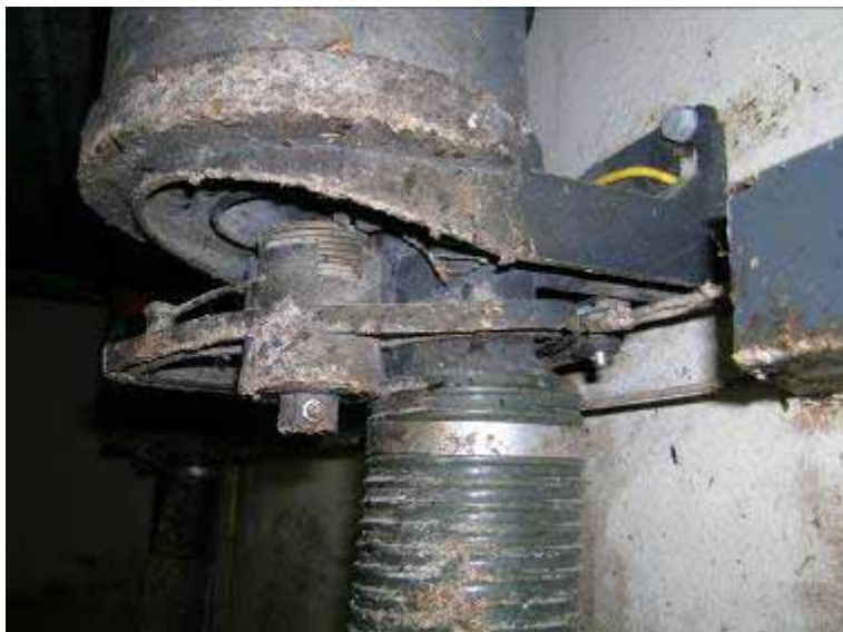
Figur 17.5. Udløsermekanikken på automaten var simpel og vel-fungerende, men havde ikke mulighed for simpel justering til at udfodre større eller mindre mængder.
