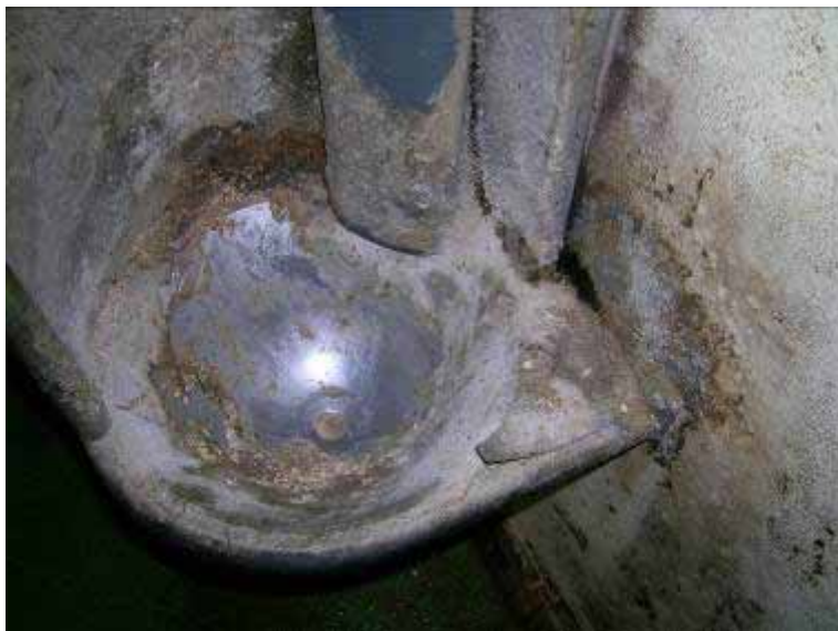
Figur 17.4. Foderautomaterne var meget let beskidte. Rengøringen var besværlig og tidskrævende. Bemærk de mange kanter og sprækker foderresterne kan ophobe sig i. Selve foderskålen kan tages op og rengøres selvstændigt. Selve skålens form er god og uden kanter, hvor foderet kan sætte sig.
