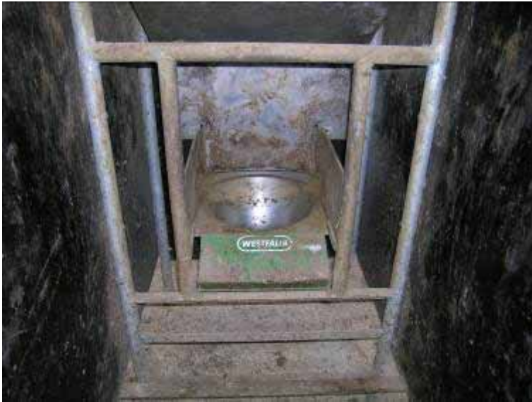
Figur 13.3. Transponderen udløser foder, når den kommer i nærheden af det grønne område. Automaten har ikke mange kanter og hjørner, men der er stadig mulighed for at forbedre indretningen, så både rengøring og hygiejne forbedres.
