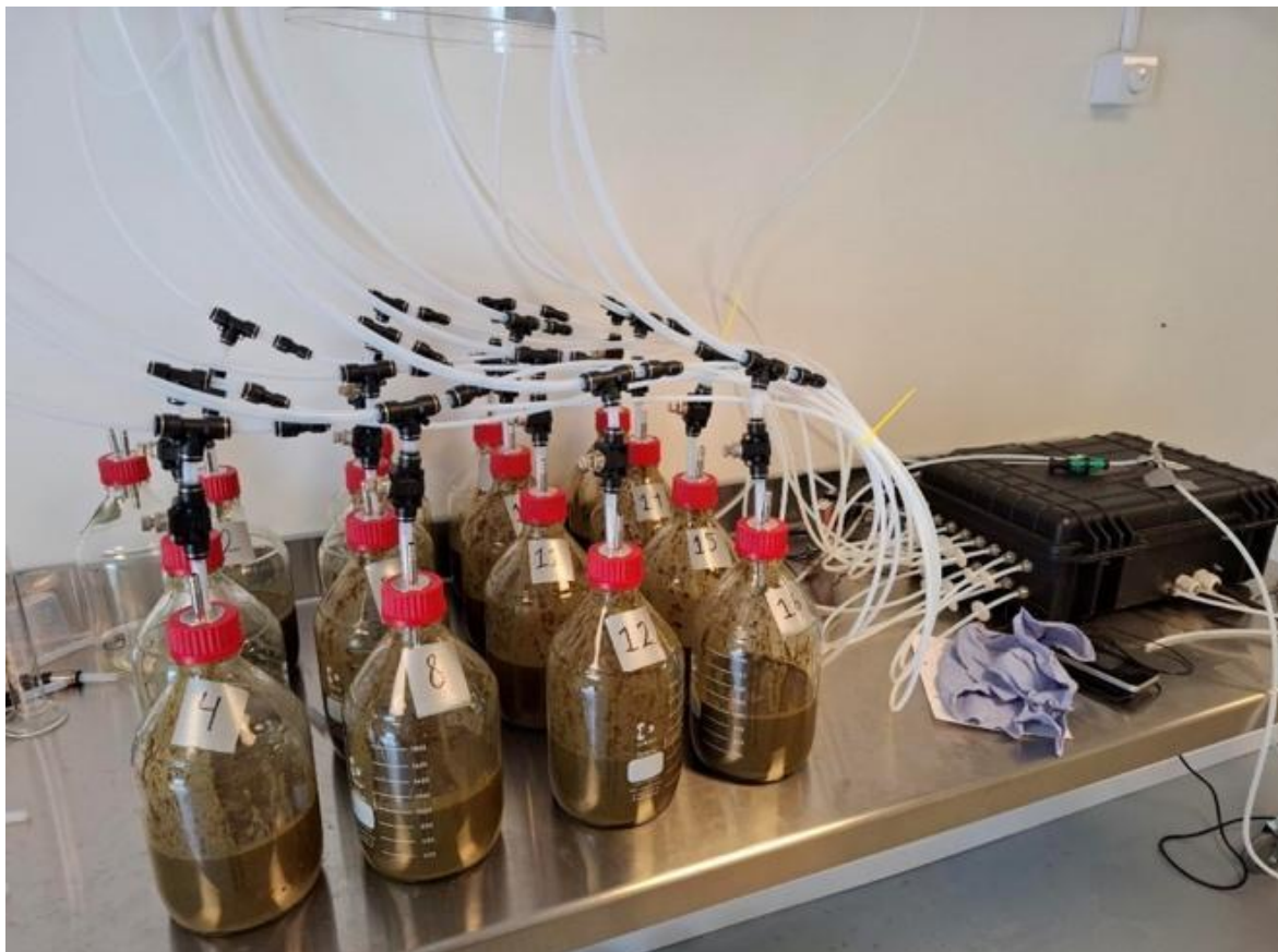
Figur 2: Forsøgsopstilling i runde 3. På billedet ses 16 markerede flasker, men flaske 1 indgik ikke i forsøgene, og denne kanal blev benyttet til måling af baggrundsluft.
