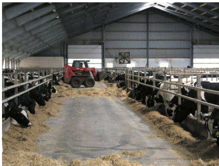
Et gennemgående foderbord, hvor fuldfoderet skubbes ind med en minilæsser.
