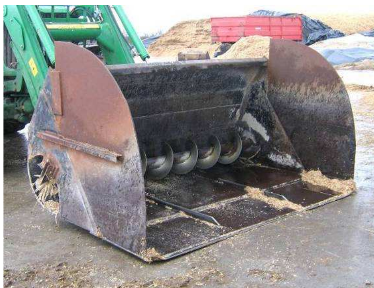
Figur 4. Frontskovl med snegl til udfodring af kraftfoder/fuldfoder.
