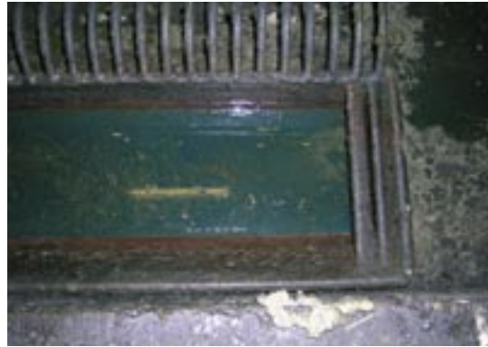
Figur 6.4: Karret er fremstillet i almindelig stål. Kobbersulfaten tærer kraftigt og levetiden er derfor begrænset. Efter knap to år, er karret meget angrebet af rust. Plast eller rustfri stål ville egne sig bedre til det hårde staldmiljø og kemikalier.
