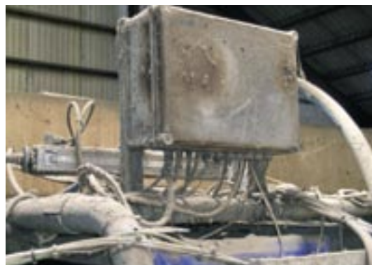
Figur 7.4: Det automatiske klovplejoprincip indeholder meget teknik. Systemet er iflg. leverandøren vedligeholdsfrit, men der er mange tekniske komponenter, som med tiden kan blive defekte.
