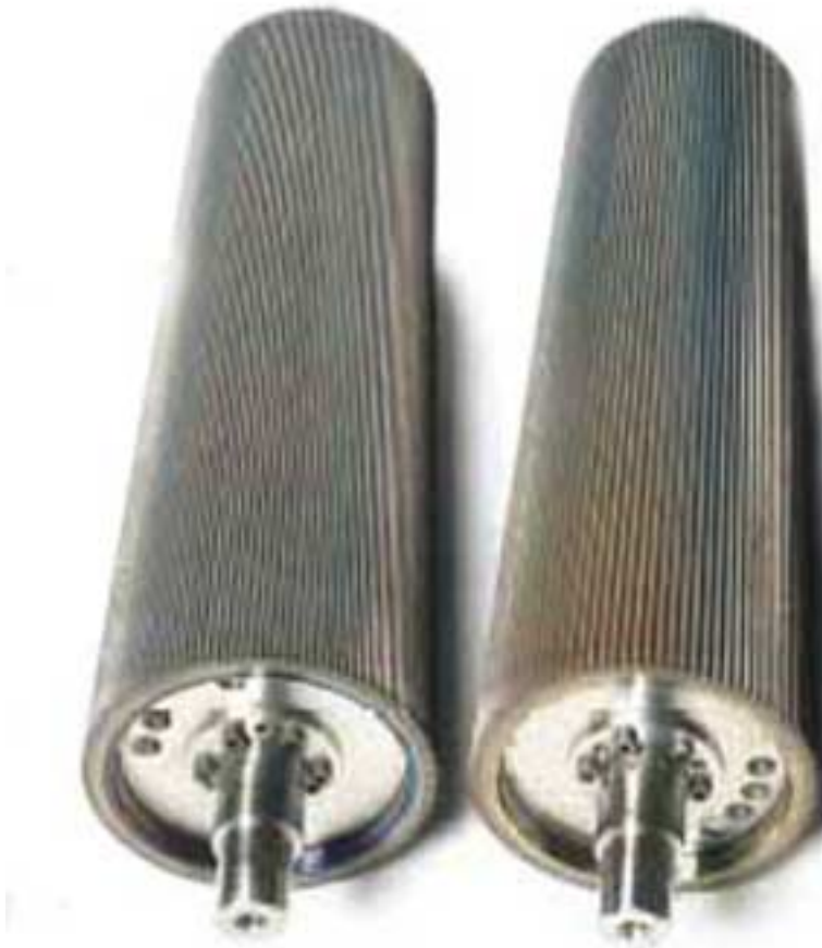
Figur 19. Principskitse af corn cracker på New Holland FX 38.
