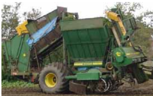
Figur 63. Roeoptageren er som følge af ombygningen forlænget med ca. 2 meter. Der var på grund af den megen nedbør i dagene før roeoptagningen monteret et Terradæk på højre side.
