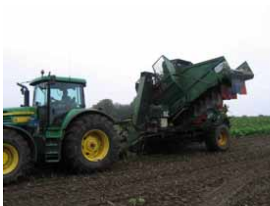
Figur 1. Thyregod T7 helplante høster med integreret roeknuser.
