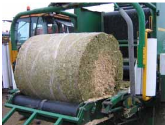
Figur 8. Rundballe bestående af kolbemajs og knuste roer + toppe. Klar til wrapning.
