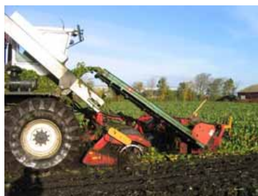
Figur 37. Bemærk det todelte transportbånd til roetoppen.
