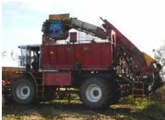
Figur 55. Selv om roeoptageren er lang, kommer den nemt rundt ved hjælp af firehjulsstyring. Knuseren, der sidder over tanken, skal sænkes under transport.
