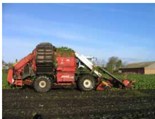
Figur 2. Selvkørende 6-rækket Tim roeoptager med påbygget roeknuser og todelt transportør til roetoppen.
