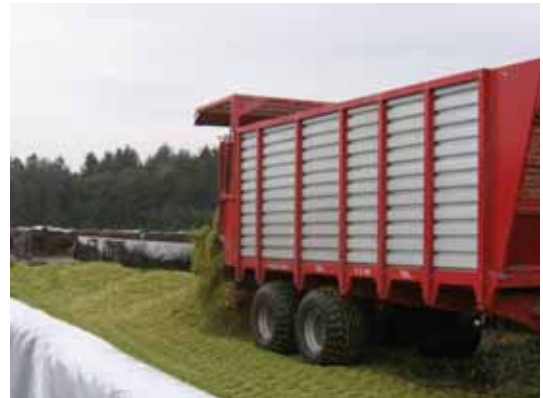
Figur 32. Aflæsning af majshelsæd fra vogn med bundkædetræk. Bemærk at majsens ligger i dynger efter aflæsservognen.
