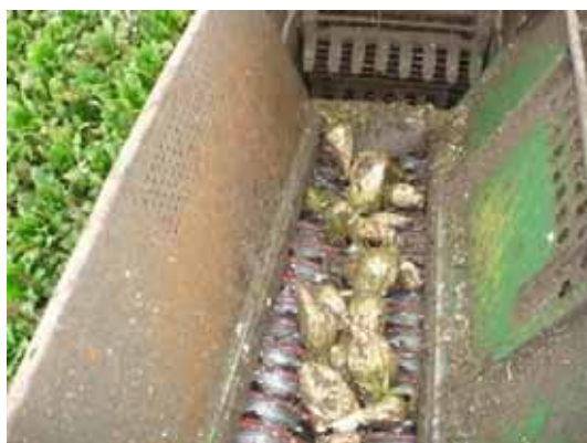
Figur 67. Knuseren er lavet af to stk. 2 meter lange tandpakkervalser, der drives rundt ved hjælp af en oliemotor.
