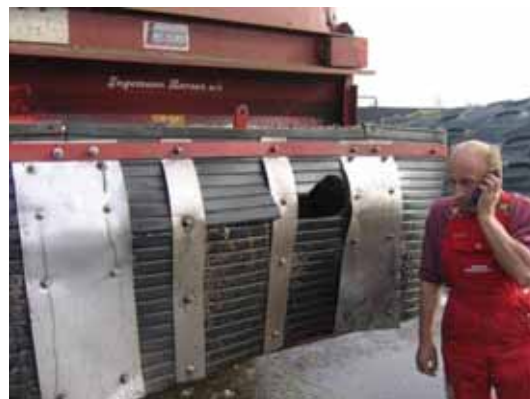
Figur 22. Hul i gummidug bag på Strautmann staldgødningsspreder.
