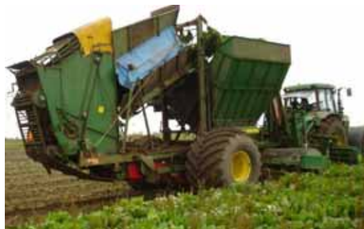
Figur 64. Bag den blå presenning sider den hjemmelavede knuser, under den ligger et bånd, der smider de knuste roestykker op i tanken.
