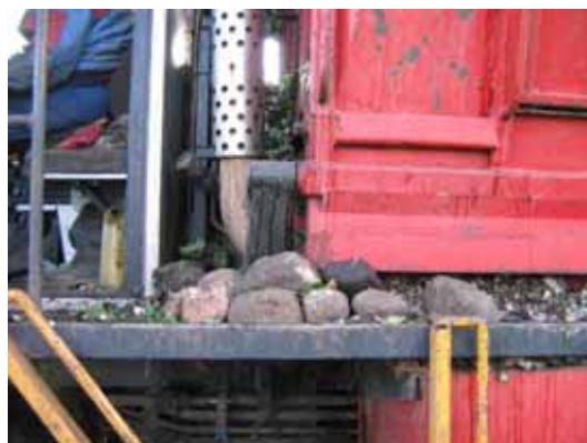
Figur 39. Mindre samling af fastklemte sten i knuseren i Tim roeoptageren. Stenene er på størrelse med roer.
