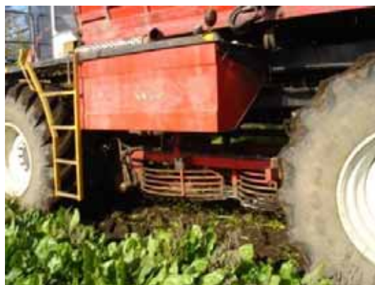
Figur 54. Roerne renses godt på de fem rouletter, hvor roerne skifter retning fire gange.
