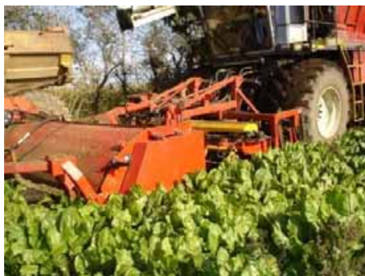
Figur 53. Billedet viser den forreste del af roeoptageren, dvs. aftopperen og skjult bag denne kitskær og sneglebord. Bundukrudt som græsser og pileurt fjernes for størstedelens vedkommende af sneglebordet.
