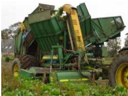
Figur 61. Den ombyggede Thyregod T5 roeoptager anvendt til aftopning, optagning og knusning af roerne.
