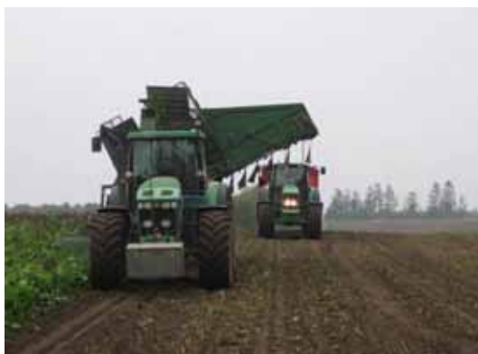
Figur 27. Optagning af roer med Thyregod T7 helplantehøster.
