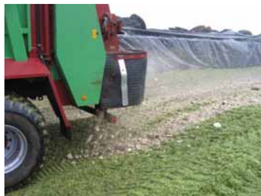
Figur 20. Bemærk, at den knuste roemasse ligesom falder i to striber efter vognen.
