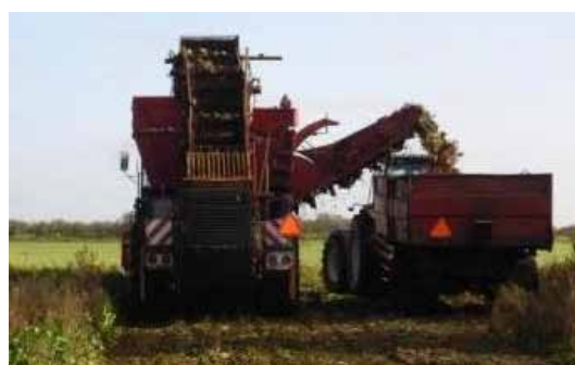
Figur 52. Det er en klar fordel ved en seksrækket optager, frem for en tre-rækket, at der allerede efter første omgang kan køres ved siden af optageren med traktor og vogn.
