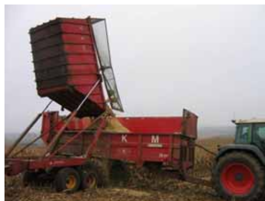
Figur 78. Omladning af snittet kolbemajs fra højtipvogn (efterspændt finsnitter) til transportvognen, der kørte kolbemajsen hjem. Bemærk spildet.
