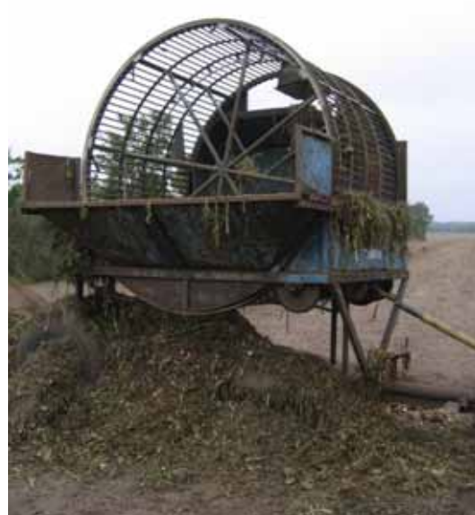
Figur 16. Roerenser ("Pariserhjul") til ekstra rensning af roerne. Kapaciteten er op til 40 tons/time.
