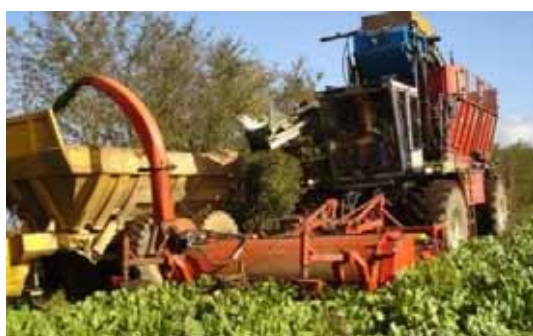
Figur 51. Roeoptager anvendt til aftopning, optagning og knusning af roerne. Ideen var, at toppen skulle med i tanken ved hjælp af en blæser og et bånd, der sider på siden af kabinen på roeoptageren. I praksis blev tanken dog så hurtig fuld, at man valgte at blæse toppen over i en vogn, der kørte ved siden af roeoptageren. Samme vogn transporterede også de knuste roer – sammen med toppen – hjem til siloen på ejendommen
