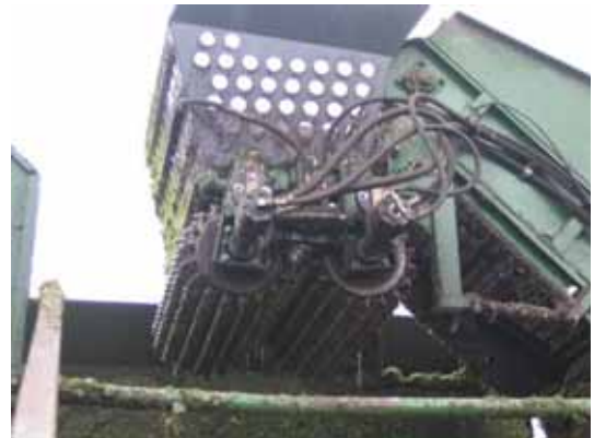
Figur 26. Nærbillede af roeknuser i tanken på Thyregod T7.
