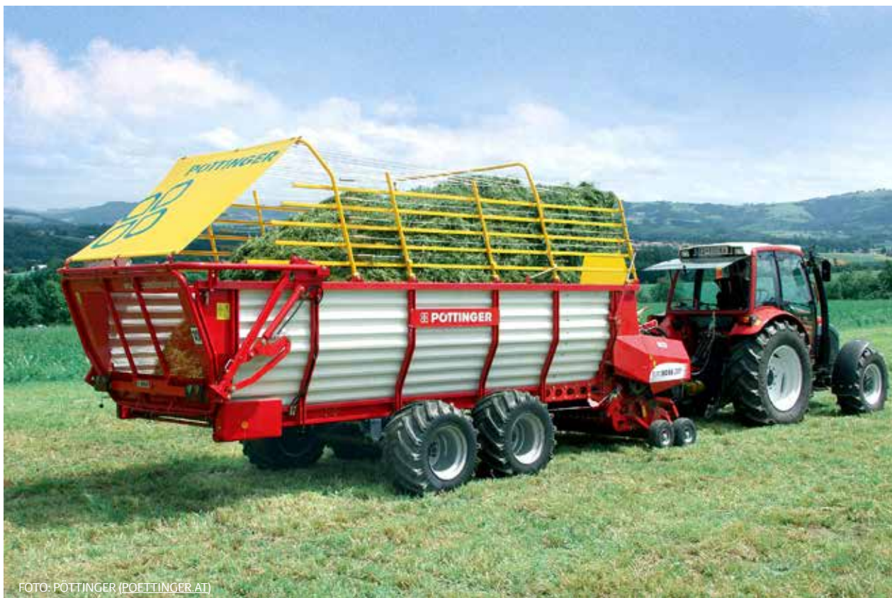
Billede 4. Opsamlevogn med to rækker knive som græsset presses op imod.
