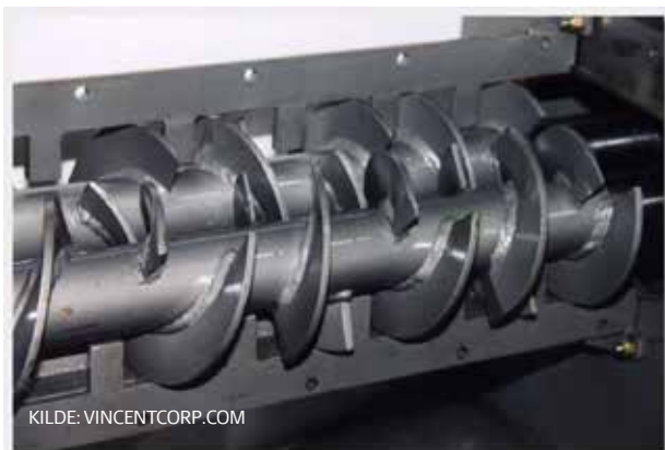
Billede 15. Dobbelt skruepresse tv. med brudte vindinger og th. ses mere tydeligt hvordan modskær går ind mellem vindingerne.
