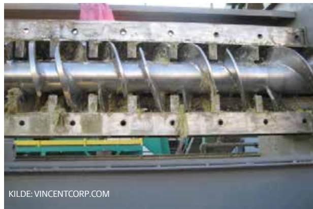
Billede 15. Dobbelt skruepresse tv. med brudte vindinger og th. ses mere tydeligt hvordan modskær går ind mellem vindingerne.
