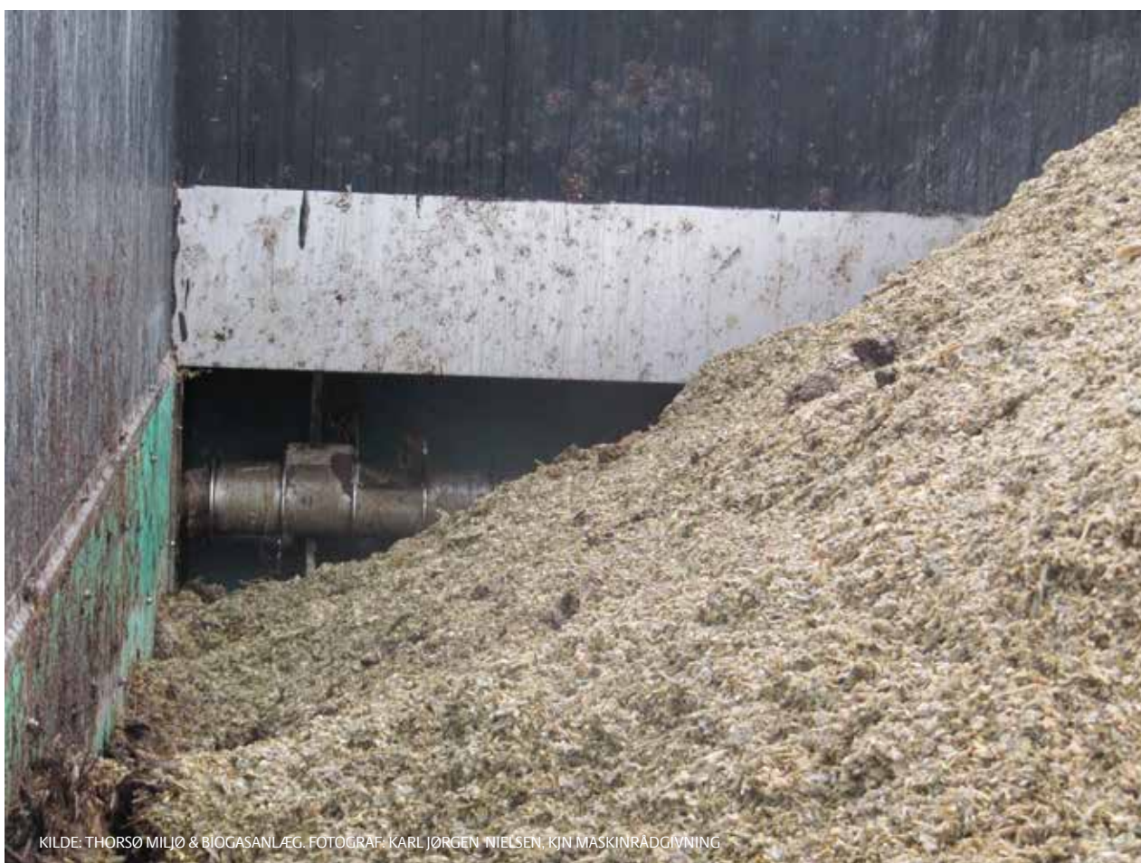
Billede 12. Modtageanlæg med vandrende gulv der fører biomassen hen mod opriveren.
