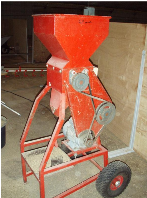
Billede 2. Udstyr til granulering af voksefoderet.
