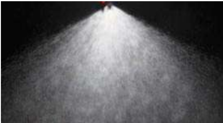
Billede 3. Den udgangsvinkel sprøjtewæsken danner ved dysen, når væsken sprøjtes ud kaldes spredevinklen. Arealet væsken rammer er større ved 110 grader end ved 80 graders spredevinkel.
