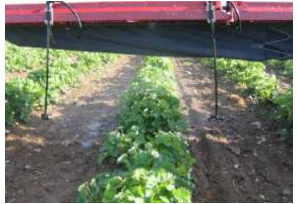
Billede 6. Droplegs monteret på en sprøjtebom giver mulighed for også at sprøjte planterne fra siden.
