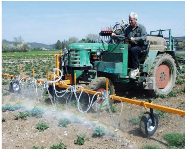
Billede 9: I flere lande anbefales en rækkesprøjte uden afskærmning til jordbær. Risikoen for afdrift og belastningen af chaufføren kan være betydelig. (Foto: J. Rüegg, 2003)
