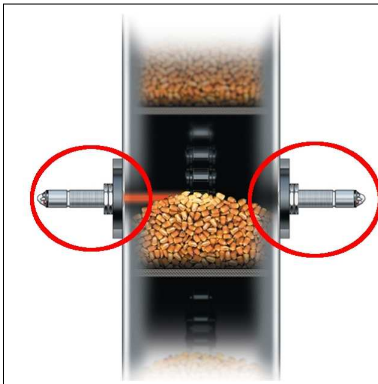
Figur 2. Udbyttmåler i Claas mejetærsker – Infrarøde sensorer på begge sider af kornelevatoren måler afgrødens rumfang – censorerne er markeret med cirkler (kilde Claas).
