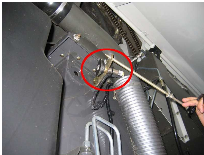
Figur 6. Mængdemåler på Claas Lexion 560 mejetærsker med infrarød sensor markeret med cirkel. (Foto: AgroTech).
