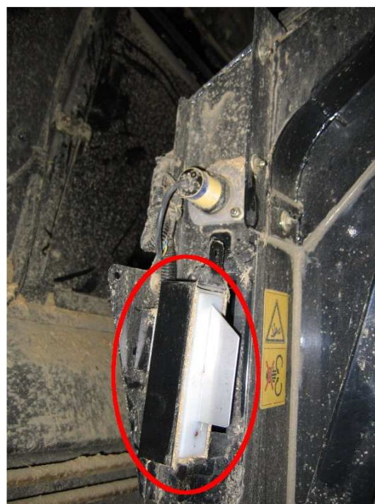
Figur 5. Fugtighedsmåleren (markeret med en cirkel) set fra siden af New Holland mejetærskeren. (Foto: AgroTech).
