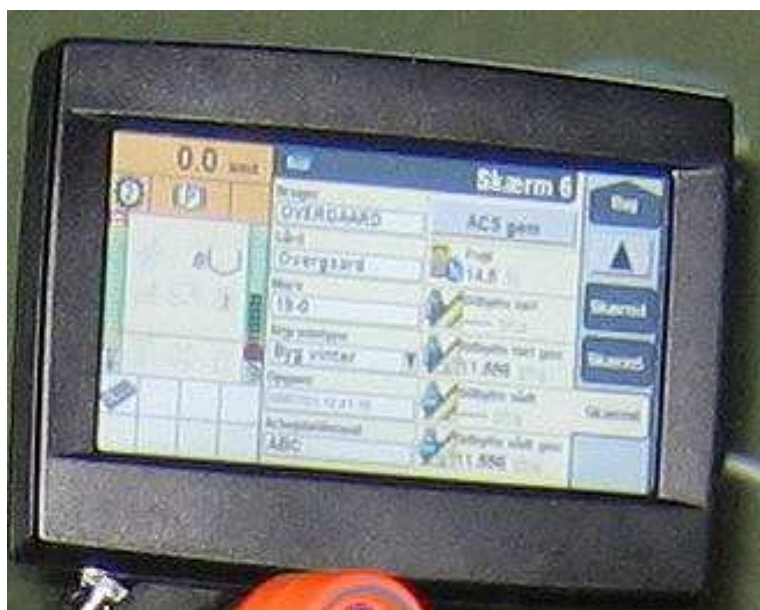
Figur 11. Trykfølsom terminal til overvågning og styring af udbyttmåleren. (Foto AgroTech).
