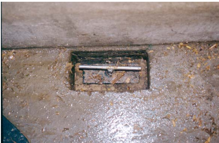
Figur 11. Betjeningen er hurtig og simpel. Vandtilførsel og afløb er en del af klovbadet. På billedet vises udløseren til afløbet.
