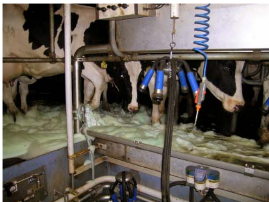
Figur 21. Forkert placering af opskumningen. Der må ikke være skum på gulvet i malkestalden.
