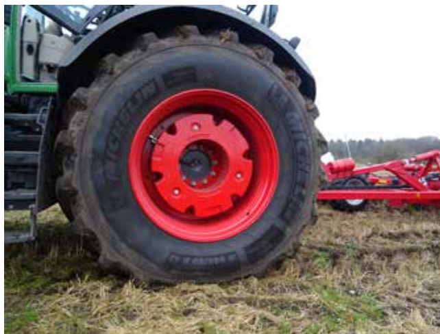
BILLEDE 4. VarioGrip muliggør individuel dæktryksregulering på for- og bagaksel.
