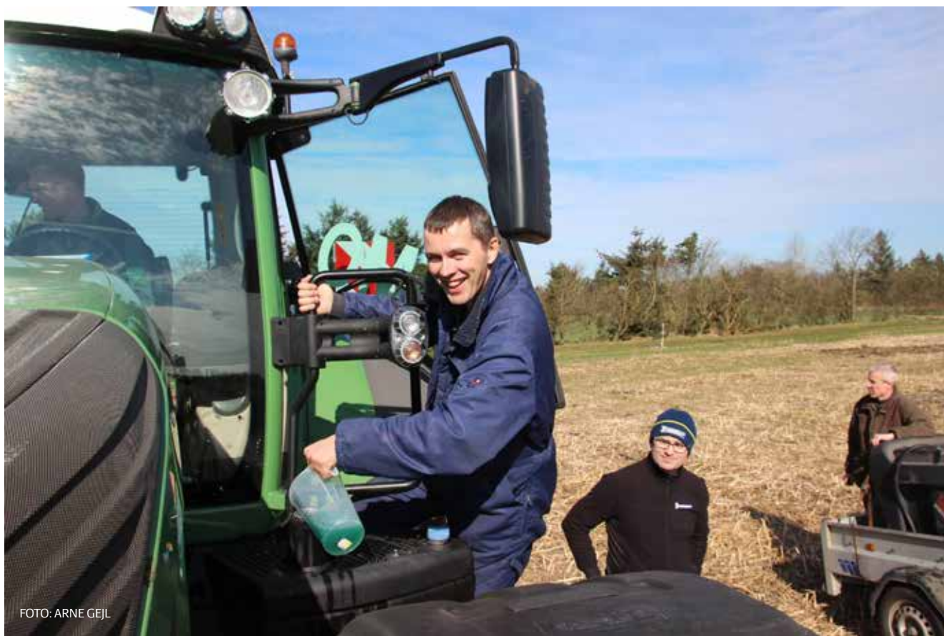
BILLEDE 2. Brændstofforbruget er opgjort ved tankning med litermål.
