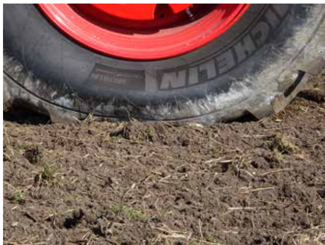
BILLEDE 5. Udfladningen ved 0,8 bar dæktryk, hvor tre ribber havde jordkontakt. Bemærk "Bælteeffekten".
