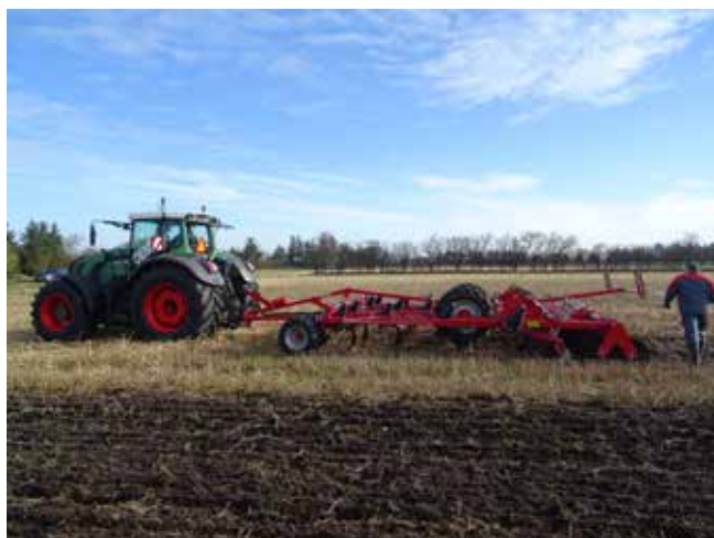
BILLEDE 3. Der er anvendt en Fendt 939 Vario med VarioGrip og en Horsch Terrano 5 FM stivtandet harve
