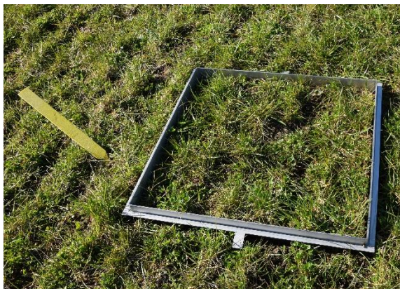
Figur 2 Rammer sat i jorden før prøvetagning. a) Rammerne sættes i jorden ved at hamre på en flad trælægte, b) Opsatte rammer.
