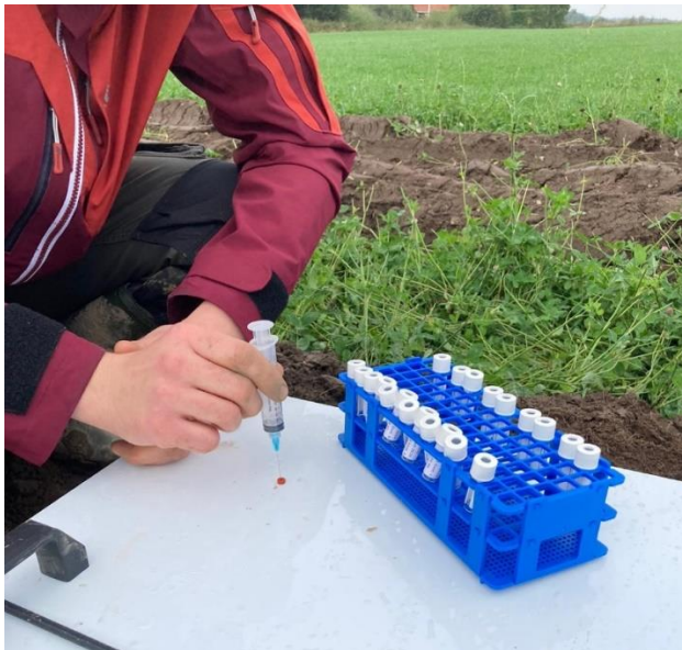
Figur 1 Her ses gasprøvetagning med sprøjte og nål fra et lukket flux-kammer.
