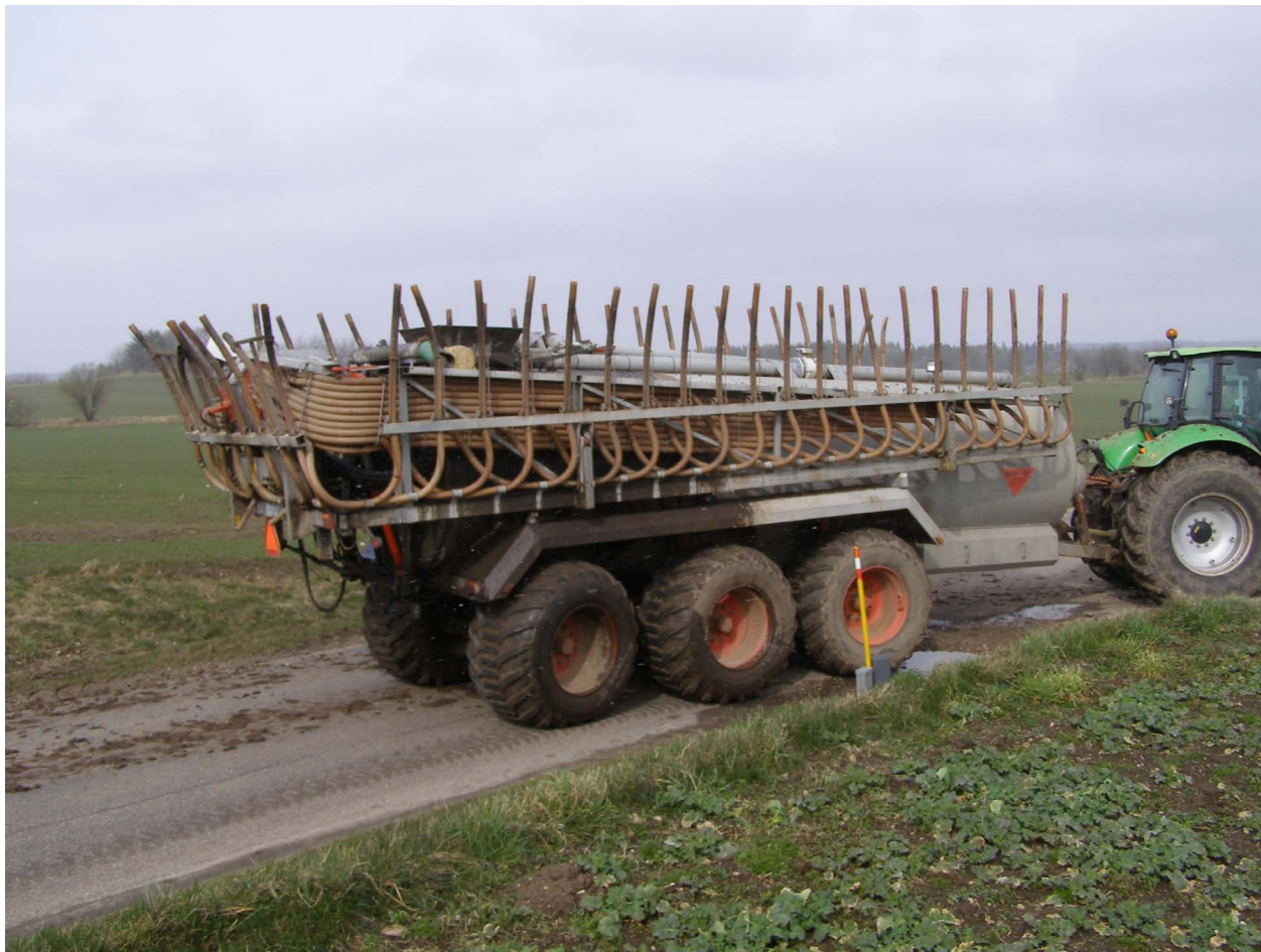
Dryp fra slangerne kan undgås ved at vippe de yderste ender op i lodret stilling. Foto: Jens J. Høy, AgroTech.
