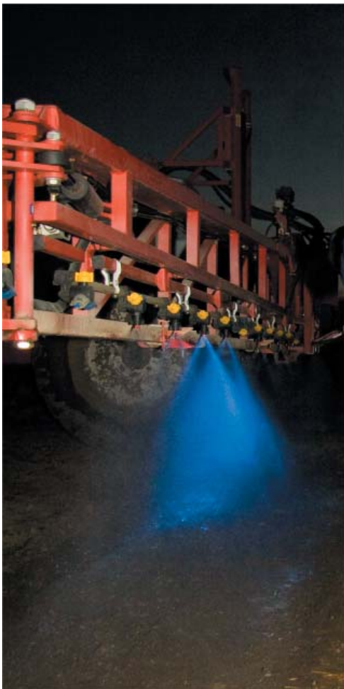
Figur 4.2 Sprøjtevæsken er tilsat optisk hvidt, som lyser op, når det udsættes for ultraviolet lys.
