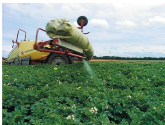
Figur 5.4 Afdrift med TWIN luftassistance slået til. Der ses en tydelig reduktion i afdriften.
