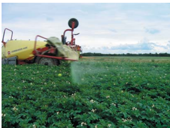
Figur 5.3 Afdrift uden TWIN luftassistance slået til. Det svarer til afdrift ved en traditionel marksprøjte.
