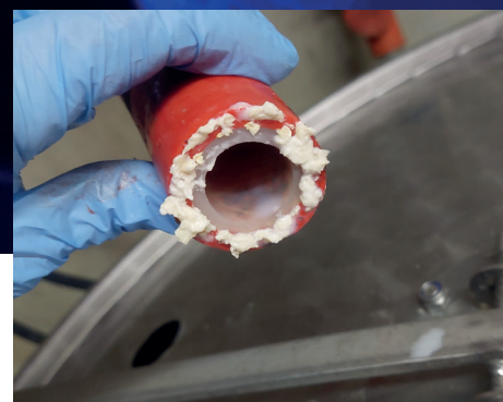
På exitslangen fra en malke­robot til alt framalket mælk ses blandt andet størknet mælkefedt. En 'kimbombe', der forurener alt mælk, som kommer ud af slangen. Foto: Line Fruergaard-Roed.
