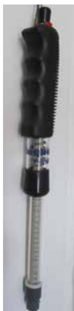
Udstyr til måling af partikelstørrelsesfordeling og brudstyrke.
