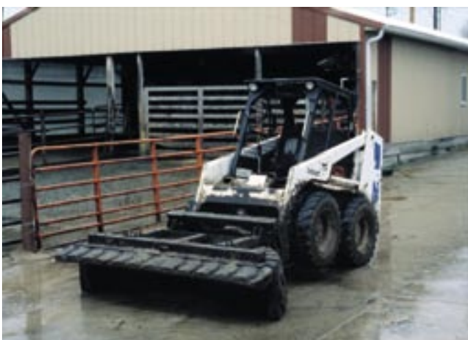
Figur 2.2: Minilæsser med overskåret traktordæk til skrabet af faste gulve.
