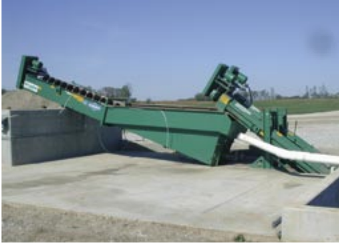
Figur 2.6 Sandseparator i aktion. Til højre for billedet fyldes den sandholdige gødning i depot, hvorfra det snegles op i separator enheden. Til venstre for billedet "afleveres" det vaskede sand.
