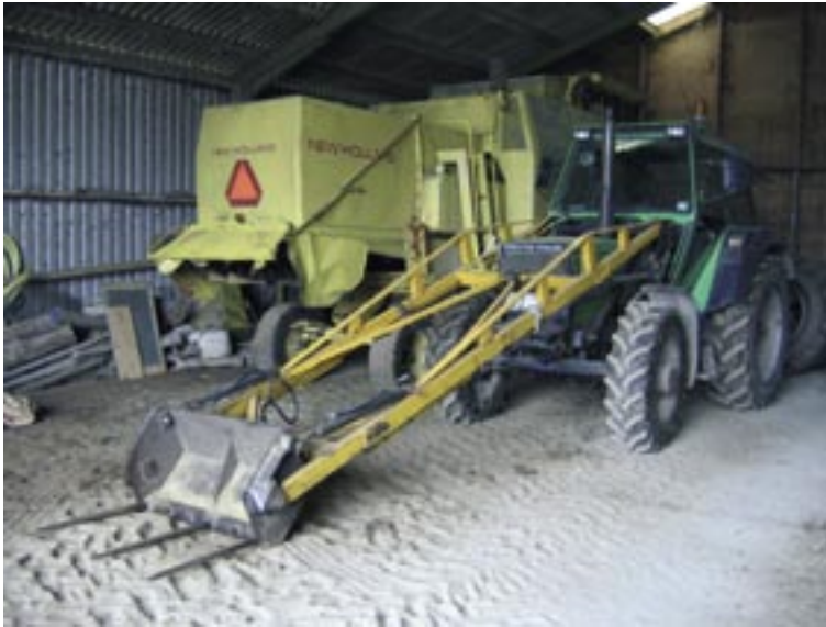
Figur 4 - Specialmonteret frontlæsser til udmugning af "Kalvehytte fælles".
