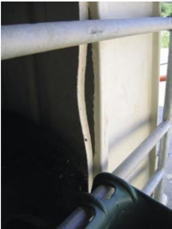
Figur 2 - Skader på "Multimax" forårsaget af kalve.
