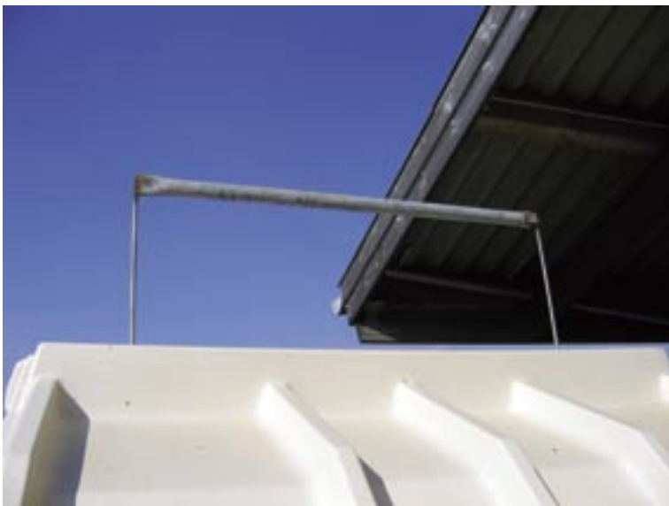
Figur 3 - Selvlavet løfteanordning til "Multimax".
