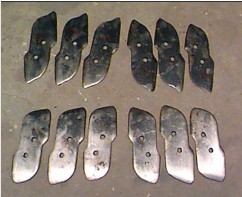
Billede 1. Billede af de slidte spidser. Kuhn (øverst) og Solbjerg (nederst).
