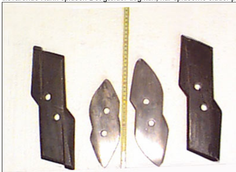
Billede 3. Billede af nye og brugte plovspidser, når begge var monteret på Kuhn skær. Kuhn til venstre og Mølbro til højre.
