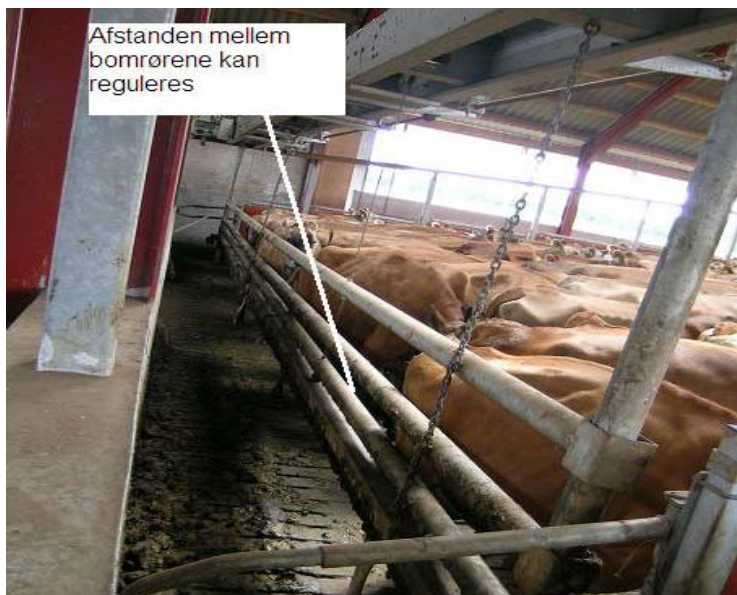
Figur 4.7. DeLaval kodriver. Der er plader på skillevæggene til returgangen for at undgå køer kommer i klemme mellem de lodrette stolper, der bærer skillevæggen, og kodriveren.
