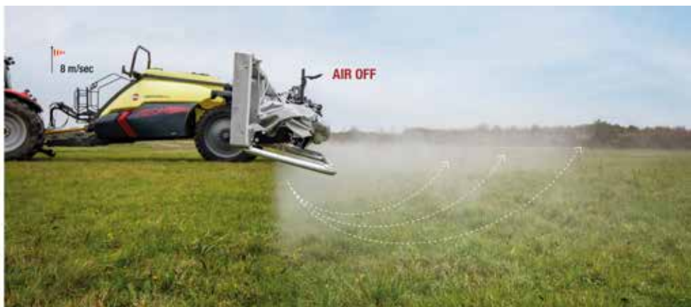
Sprøjtning med og uden luft fra TWIN-systemet ved 8 m/s. Det svarer til at køre med 10 km/t og en modvind på 5 m/s.
