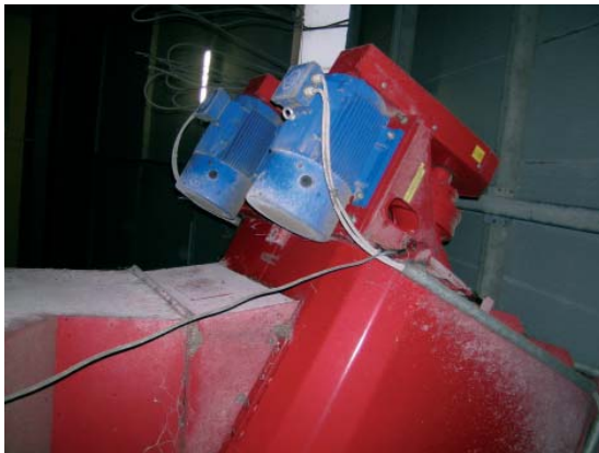
Figur 3.11. Blanderen drives af to store el-motorer. Størrelsen af motorerne afhænger af blanderens størrelse. Der er ingen problemer med at trække sneglene selv når foderet indeholder wrapballer.
