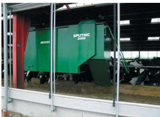
Figur 3.13 Hængebanevognen betjenes via terminalen. Udfodringen er kun aktuelt til en side og sker vha. en simpel sleske
