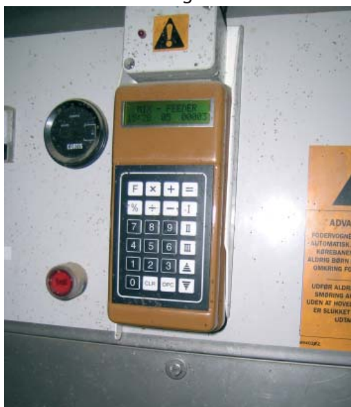
Figur 3.33. Betjening og programmering foregår via et display. Betjeningen kræver interesse og kendskab til elektronik.
