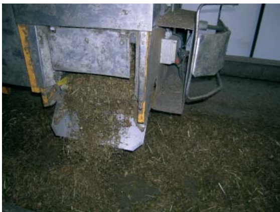
Figur 3.29. Udfodringen sker via en bundkæde og et tværbånd. Resultatet er ensartet og præcist.
