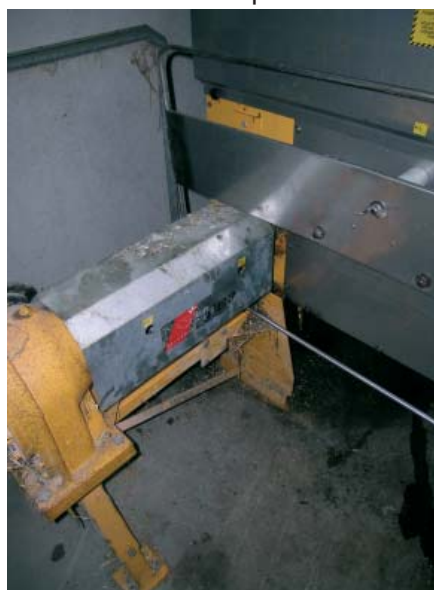
Figur 3.34. Blandingen sker ved hjælp af en stationær el-motor hvor hængebanen kører automatisk hen og kobler på.
