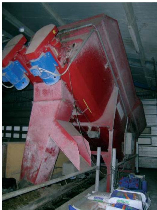
Figur 3.8. Den stationære blander hvor foderet mixes inden det udfodres på båndet.
