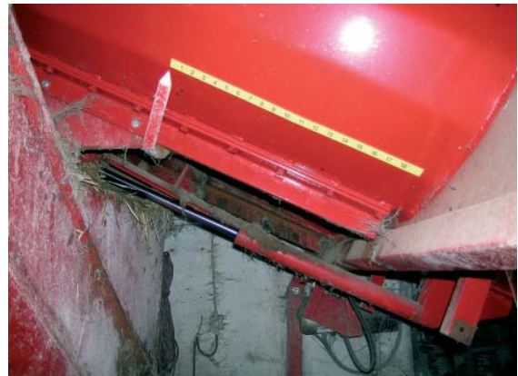
Figur 3.12. Udfodringsmængden justeres via et spjæld der åbnes/lukkes. Dermed varieres foder-mængden desværre på baggrund af volumen frem for vægten. Dette besværliggør en præcis justering.
