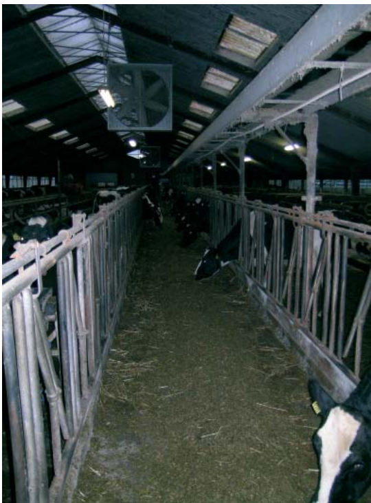
Figur 3.1. Båndet kører over foderbordet. Efter foderet er kørt ud på båndet kører en elektrisk skraber retur og skubber foderet af båndet og ned på foderbordet.
