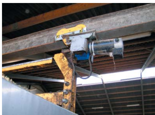
Figur 3.36. Vognen drives af to el-motorer. Den er op hægt i vejeceller som er sammenkoblet med fordelebordenes teknik.
