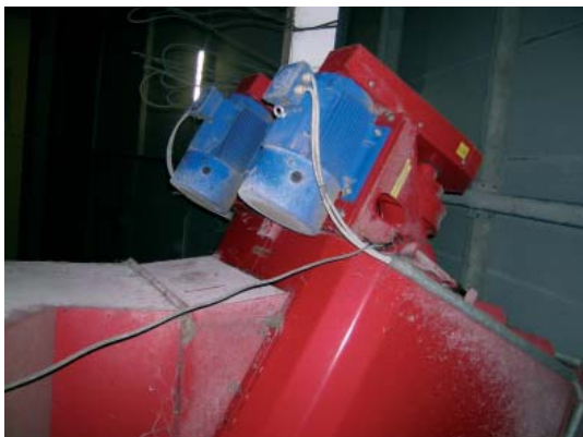
Figur 3.5. Blanderen drives af to store el-motorer. Størrelsen af motorerne afhænger af blanderens størrelse. Der er ingen problemer med at trække sneglene selv når foderet indeholder wrapballer. Der stilles dog krav til en kraftig strømforsyning.
