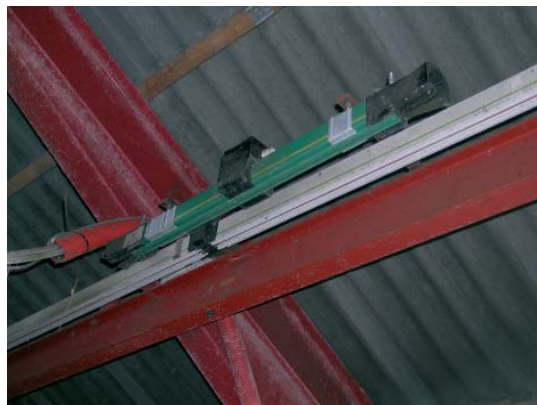
Figur 3.16. Vognen er ophængt i en skinne og trækkes af en el-motor. Skinnen til venstre er el-skinne som forsyner vognen med el under drift. Desuden ses aktiveringsskinne til foderbåndet.
