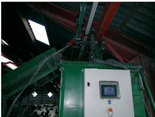
Figur 3.15. Betjening og programmering foregår via en touch screen. Betjeningen kræver begrænset interesse og kendskab til elektronik og er simpel og velfungerende.
