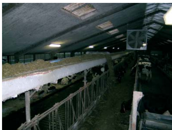
Figur 3.4. Foderet køres ud på et transportbånd, hvorefter en skinne skraber foderet af. Det drives af el-motorer.
