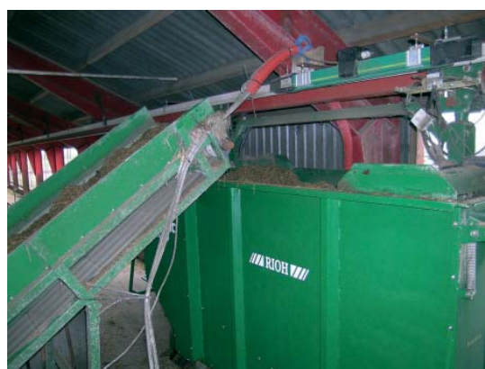
Figur 3.14. Vognen fyldes med bånd som er forbundet med en mobil/stationær blander. Foder-spildet er meget begrænset.
