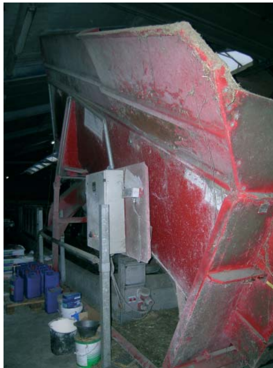
Figur 3.2. Den stationære blander hvor foderet mixes inden det udfodres på båndet.
