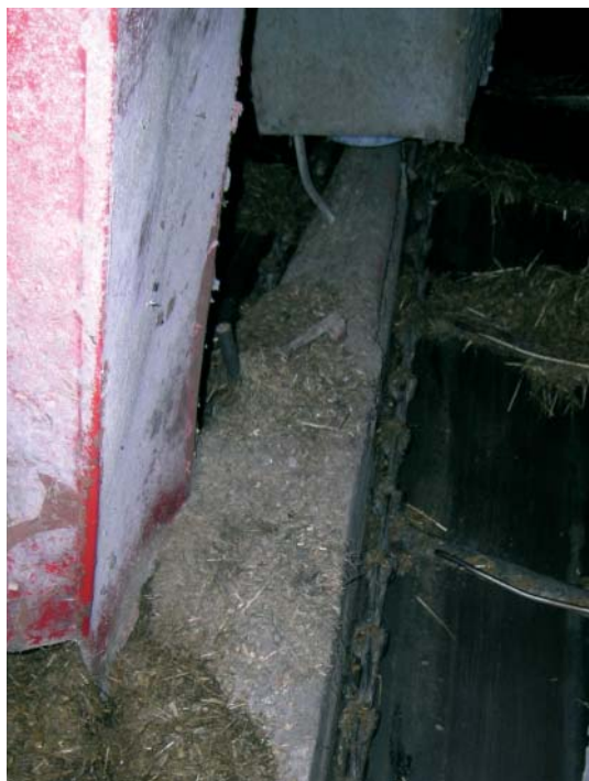
Figur 3.10. Foderet trækkes rundt på bordet via et kædetræk med skrabevinger. Det drives af en elmotor.
