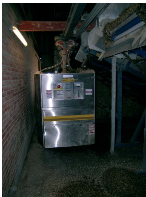
Figur 3.20. Vognen fyldes via fordelerbord eller blander. Foderspildet kan være stort hvis overgangen ikke er konstrueret godt. Bemærk foderet på gulvet.
