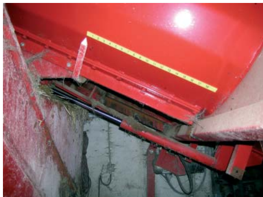
Figur 3.6. Udfodringsmængden justeres ved at åbne lukke for et spjæld. Justeringen foregår via en skala.
