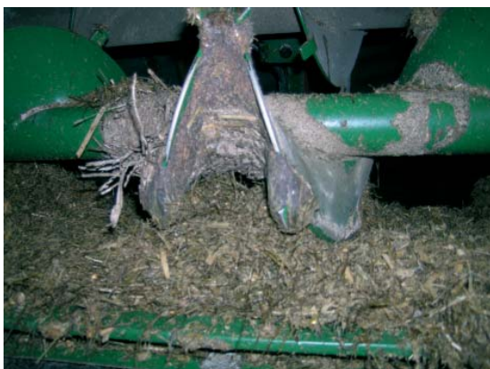
Figur 3.17. Udfodringen sker vha. en bundkæde og to tværgående snegle. Resultatet er ensartet og præcist.
