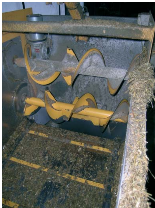
Figur 3.30. Her bundkæde og snegle som trækkes af en elmotoren i venstre hjørne. Bemærk sider og bund i rustfrit stål.
