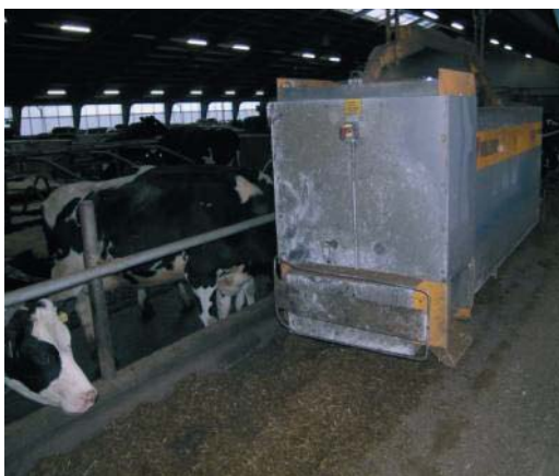
Figur 3.25. Hægebanevognen kører typisk 5-8 gange dagligt. Udfodringen kan ske til begge sider via et tværbånd.
