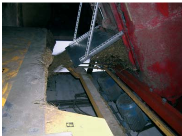
Figur 3.26. Vognen fyldes direkte fra den stationære blander. Foderspildet er meget begrænset.
