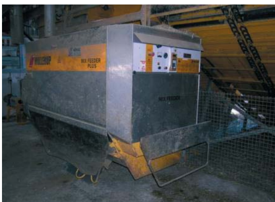
Figur 3.31. Hængebanevognen betjenes via terminalen og udfodrer via en låge.
