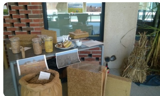
Isoleringsmateriale lavet af dunhammer i Tyskland. Foto: Frank Bondgaard, SEGES Innovation.
