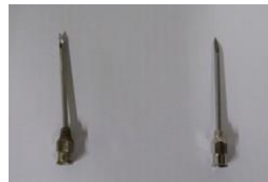
Forskellen på en ny kanyler (til højre) og en kanyler, der er brugt 6 gange (til venstre)
