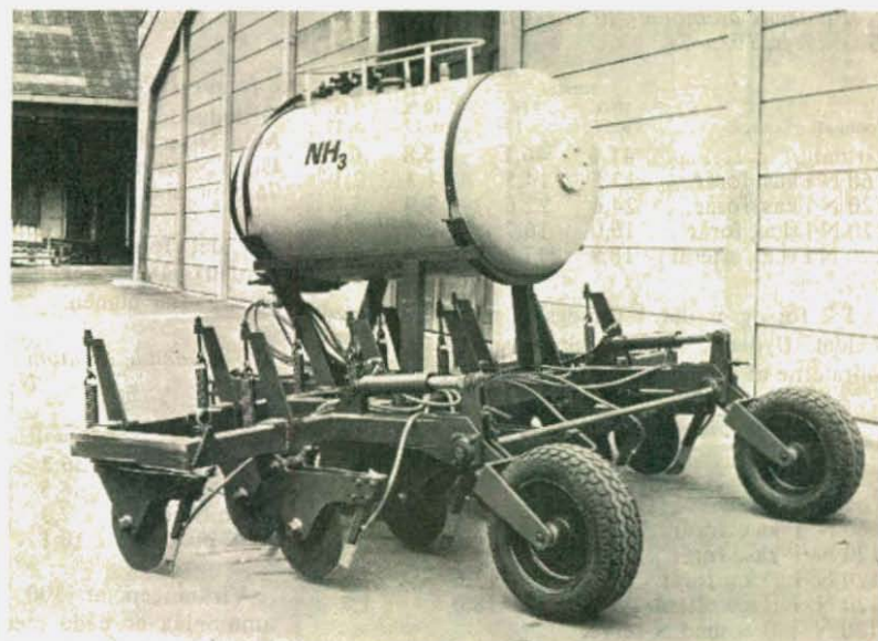
Ammoniaknedfælder til anvendelse i græsmarker og vintersæd. De enkelte skær er fjedrende op-hængt og består af rulleskær og nedfældertand, der følger tæt på skæret.
