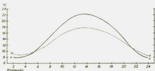
Figur 24. Lufttemperaturen i læ i relation til klokkeslet. Gennemsnit af 7 døgn i juni 1974. O = 60 meter fra læskærmen (uden læ). X = 4 meter fra læskærmen (i læ).
