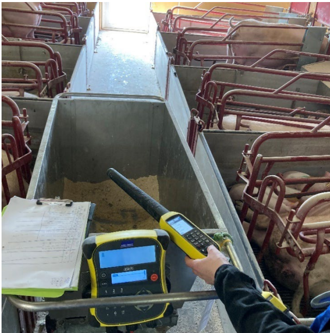
Foto 1. Grisene fik elektroniske øremærker, så nummer, vægt og vejedato automatisk blev registreret, når en gris blev lagt i vægtvognen
