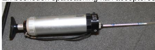
Pumpe og rør til måling af ammoniak
