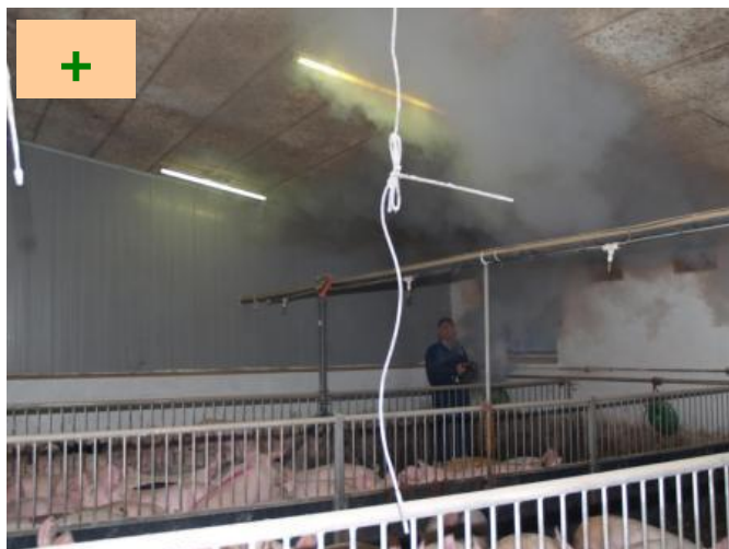
Pkt. 1. Kontrol af luftbevægelser via røg
