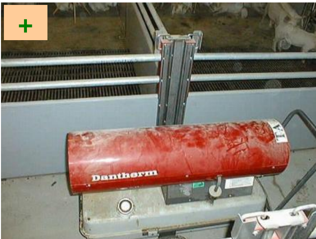
Udtørring med varmekanon (7368)
