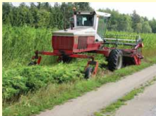
Skårlægning af hamp i én etage. Skarpsleben Busatis dobbeltkniv har klarer arbejdet uden problemer. (Foto: Erik Silkjær Pedersen, Djursland Landboforening).
