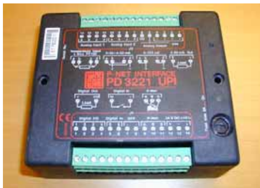
Figur 28. Procesenheden, som forbinder vandurene med interfacet i pc'en.
