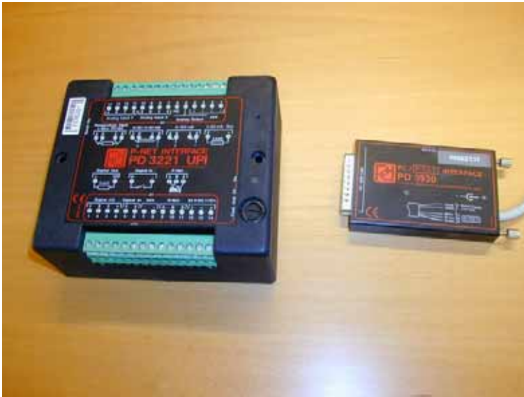
Figur 32. Interfacet (th) placeres bag i pc'en. Den er forbundet med procesenheden (tv), som er placeret i stalden og er bindeled mellem interfacet og vandurene.
