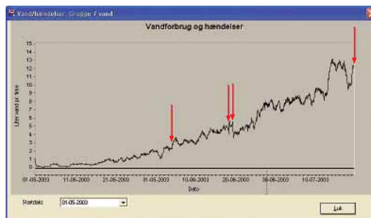
Figur 24. FarmWatch® skærbillede af alarmer for afvigende vandforbrug på vandkopper fra gruppe 7. De røde pile angiver alarmtidspunkterne på koppers vandforbrugskurve. Grænse-niveauet er opsat efter FarmWatch®'s anbefalede niveau.
