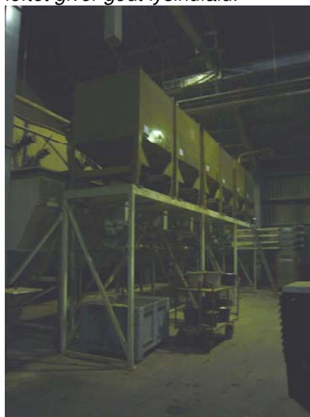
Figur 4.14. Siloer til tilskudsmidler – bemærk påfyldning fra oven.
