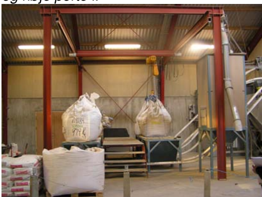
Figur 4.3. Et godt alternativ til en truck – et ophængt hejseværk til storsække.
