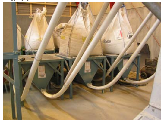
Figur 4.4. Mineralpåslag hvorpå storsækkene kan stå, mens de langsomt tømmes.
