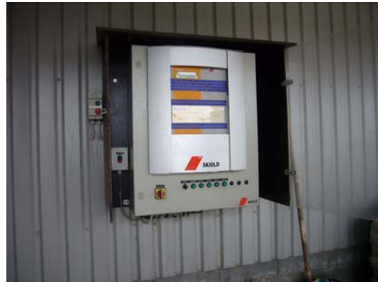
Figur 4.16. Hele anlægget styres af en Skiold-computer, hvor der let kan indtastes nye mængder. Dog ikke på antallet af køer, men på % af blandingen.
