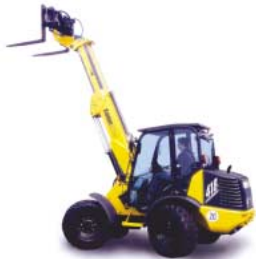
Figur 85. Kramers mindste læsser 418 T med løftekapacitet på 2.200 kg til 4,55 meter.
