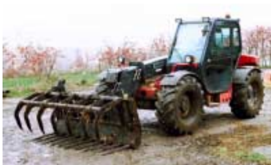
Figur 91. 8937 er Massey Fergusons næst største læsser og deres mest solgte model til landbruget. Motoren er sidemonteret og har 78 kW/106 hk.
