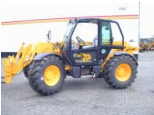
Figur 77. JCB's 530-70 Farm Special Super med sidemonteret motor og 90 kW/120 hk.
