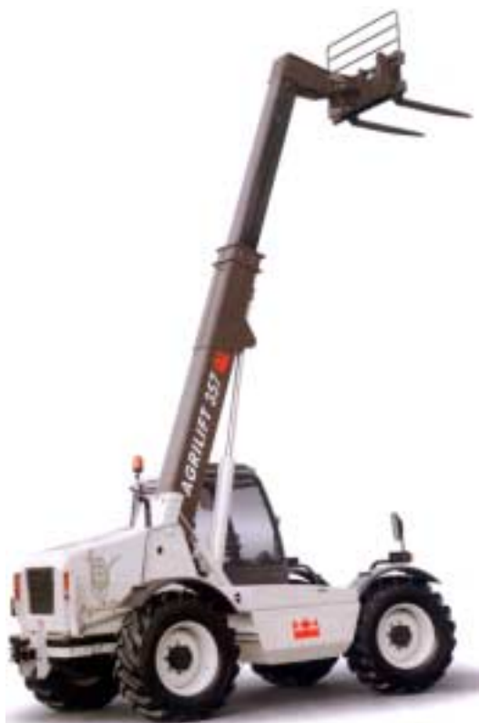
Figur 109. Terex 357 Agrilift med motor bag førerhuset og 78 kW/107 hk Perkins motor.
