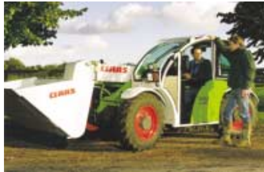
Figur 71. C40 er en lille kompakt læsser, som anbefales, hvor pladsen er trang. Med en højde på 1,96 meter og bredde på 1,80 meter er den meget handy.
