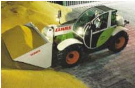
Figur 70. K70 er Claas' største læsser. Motoren er placeret til højre for førerhuset på alle modeller. Bemærk den kombinerede for- og tagrude.
