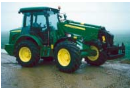
Figur 79. John Deeres knækstyret model 3800 med 81 kW/110 hk Power-Tech motor.
