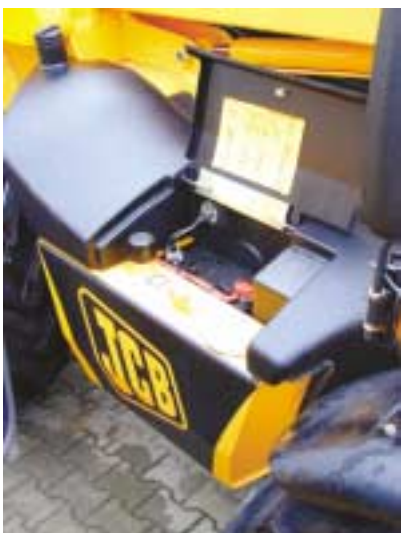
Figur 75. Tank og batteri er placeret til venstre for førerhuset.
