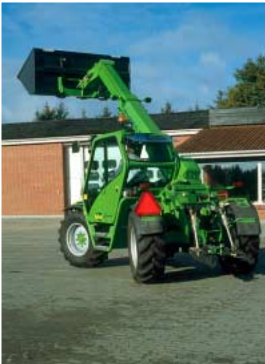
Figur 95. Multifarmeren er udstyret med PTO og lift, så den også kan fungere som traktor.
