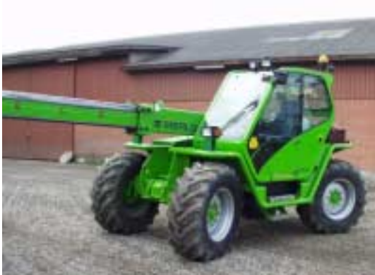
Figur 93. 33.7 KT. Bemærk den kraftige bom hele vejen rundt, som sikrer læsseren mod større skade ved påkørsler. Den er på alle Merlo læssere.
