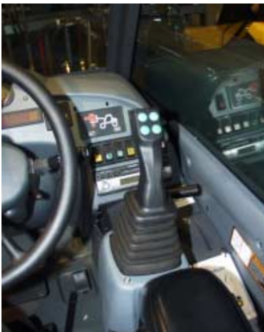
Figur 99. LM-400 modellerne er alle joystickbetjente. LM-600 er med håndtag.
