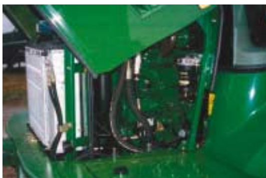
Figur 81. Motoren er placeret bag førerhuset. Der er adgang fra begge sider.
