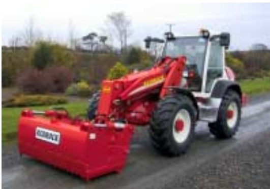
Figur 100. TH 280 er den mindste af de fire Redrock modeller. Den er knækstyret med motoren bag førerhuset og ind- og udstigning fra begge sider.
