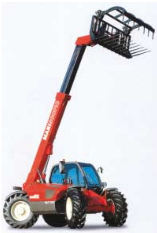
Figur 86. Maniscopic MLT 730 med sidemonteret motor og løftekapacitet på 3.000 kg og 7 meter. Den kan leveres i tre udgaver med henholdsvis 81, 104 og 123 hk.
