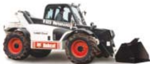
Figur 69. Motoren er monteret til højre for førerhuset på alle Bobcat modeller.
