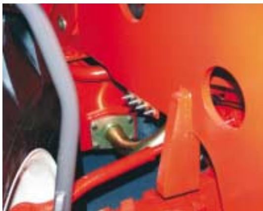
Figur 88. En smart løsning er smørepulten på MLT 730, som giver let adgang til servicepunkter.
