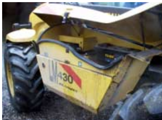
Figur 98. Batteri og tanke er placeret på siden af læsseren.
