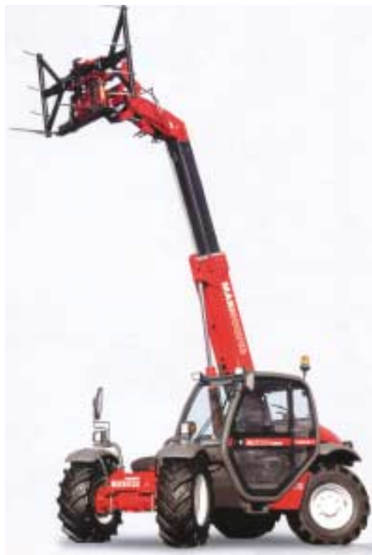
Figur 87. MLT 526 er en af Manitous mindre læssere, som også fås i en "Compact" udgave. Den er knap 20 cm lavere end standarden.
