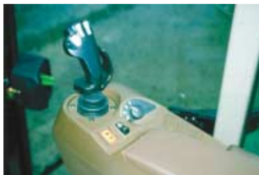
Figur 80. Joysticket er monteret med en sikkerhedskontakt, som skal påvirkes for at betjene teleskoparmen.
