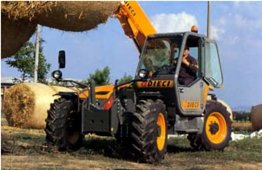
Figur 72. Dieci Agri er udviklet specielt til landbruget. Den er blandt andet udstyret med større motor og hjul. Topharten er 40 km/t.
