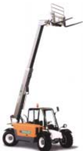
Figur 67. TH 2306 med 47 kW/63 hk. Løftekapacitet på 2.300 kg til 5,7 meter.
