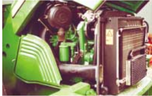
Figur 83. Motoren på model 3200 og model 3400 er en 74 kW/100 hk Power-Tech fremstillet af John Deere selv.
