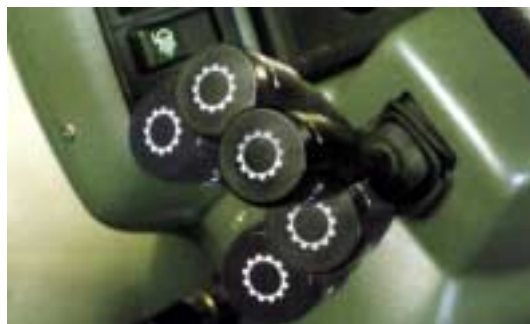
Figur 92. Gearskiftet mellem høj og lav foregår ved hjælp af en kick-down funktion.
