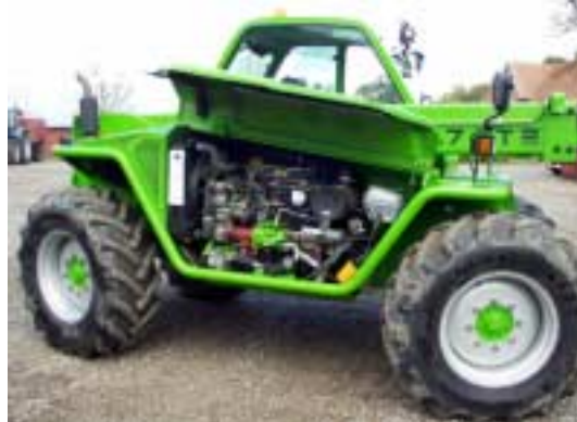
Figur 94. 33.7 KT er udstyret med en 80 kW/107 hk Perkins motor.
