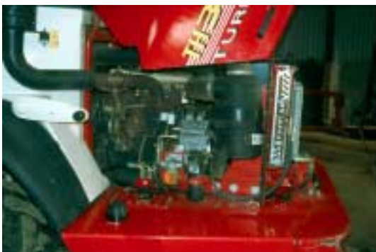
Figur 102. Motoren på TH 300 er fra Perkins og yder 80 kW/108 hk.
