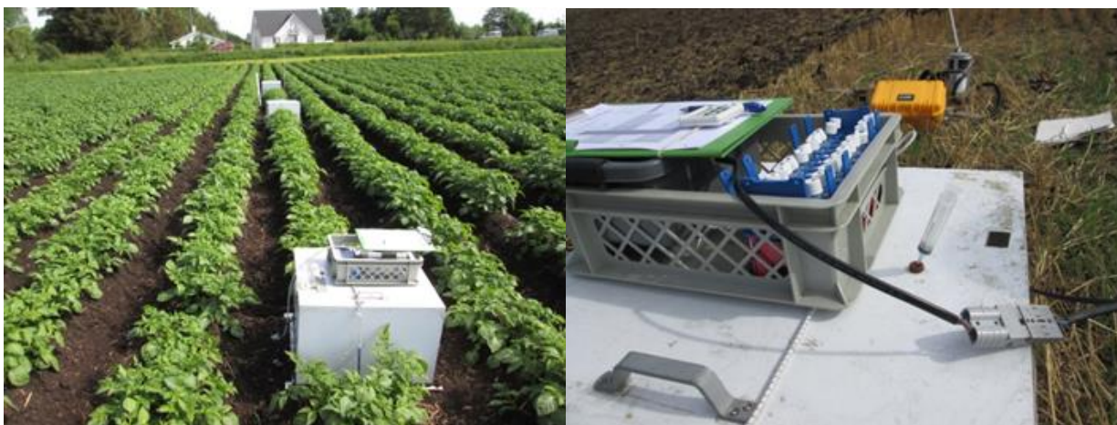
Figur 3. Til venstre: målekasser placeret på rammer i kartoffelmark ved måling af gas fluxe. Til højre: nærbillede af udtagning af gasprøver med 10-mL sprøjte. Foto: Tanka Kandel
