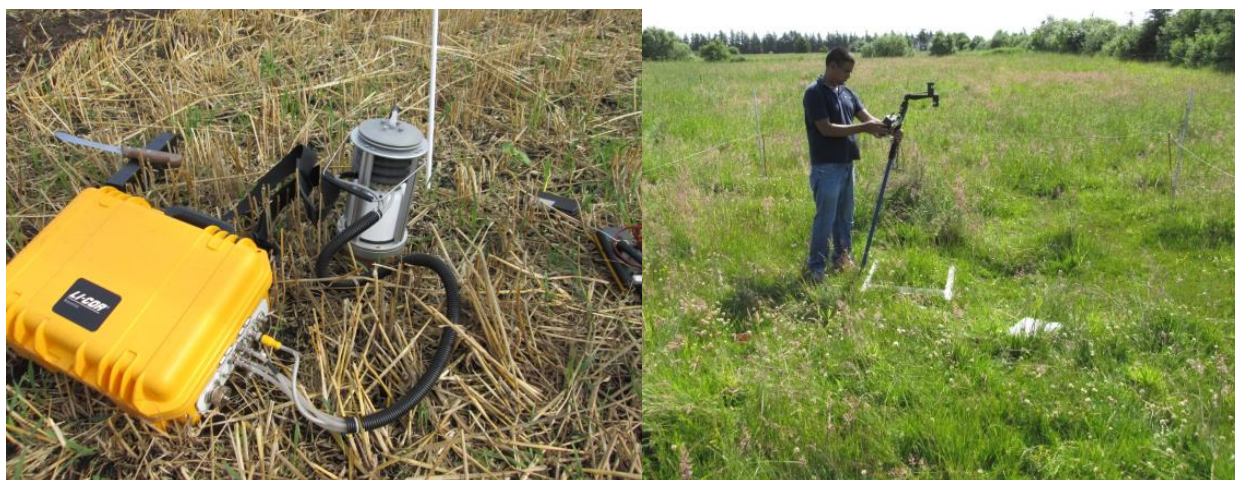
Figur 4. Til venstre: bærbart udstyr til måling af jordrespiration. Til højre: måling af biomasse udvikling ved RVI metoden. Foto: Tanka Kandel og Hans Peder Andersen
