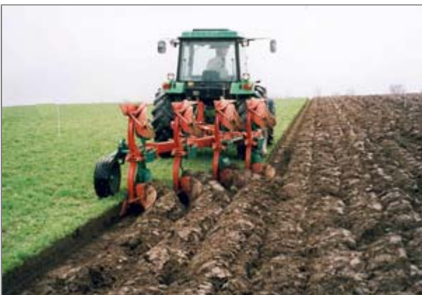
Foto: Begge hjulpar holdes ude af furen ved onland pløjning. Det gør det let at ændre bredden på forreste fure. Fotograf: Peter Storgaard Nielsen, Bygholm
