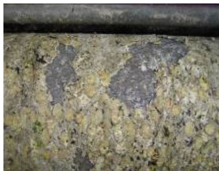
Foto 10 og 11. Hestebønnerne, der var ret tørre, klæbede til valserne og gav anledning til driftsstop når afstanden var 0,2 mm mellem valserne. Det var muligt at valse hestebønnerne, når afstanden mellem valserne blev øget til 1,5 mm.
