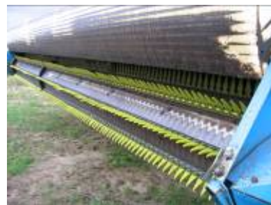
Foto 1, 2 og 3. I hestebønner var det nødvendigt at lægge skjoldet tæt på ribberotoren, for at få alle bælgene frigjort fra stænglen.
