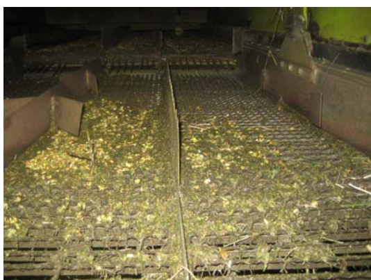
Foto 6. Mejetærskning af lupin, som havde et relativt højt vandindhold, gav anledning til tilstopning af soldene.
