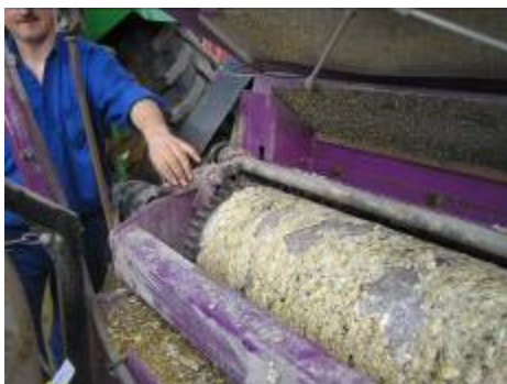
Foto 10 og 11. Hestebønnerne, der var ret tørre, klæbede til valserne og gav anledning til driftsstop når afstanden var 0,2 mm mellem valserne. Det var muligt at valse hestebønnerne, når afstanden mellem valserne blev øget til 1,5 mm.
