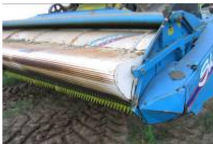
Foto 1, 2 og 3. I hestebønner var det nødvendigt at lægge skjoldet tæt på ribberotoren, for at få alle bælgene frigjort fra stænglen.
