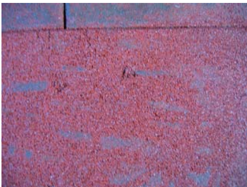
Figur 5.14 Små huller i underlagets overflade i boks 3.
