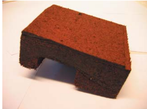
Figur 5.13 Hule kanaler på undersiden af underlaget i boks 4.
