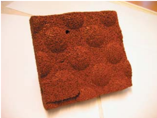
Figur 5.12 Dupper på undersiden af underlaget i boks 3.
