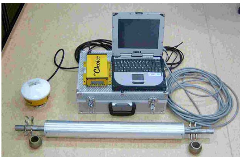
Figur 3. Mullvadssystemet består av en GPS, fäldator och detektor (Van Egmond m.fl. 2008).
