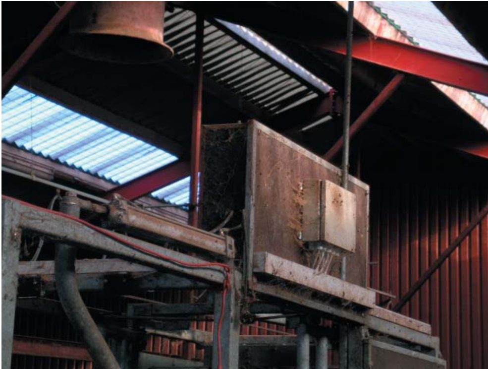
Figur 4.8 I frostvejr kan cylinderen til separationslågen fryse.
