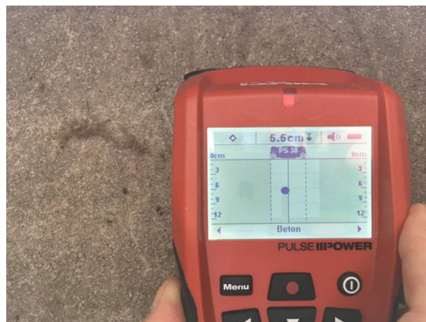
Billede 29. Hilti PS38, som er anvendt til registreringerne af armering i betonelementer
