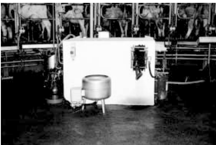
Figur 4.15 Eksempel på bordarrangement, hvor der mod malckerens plads er en bordplade med håndvask og modsat, som det ses, en beholder til kalvemælk og spuleslange.
