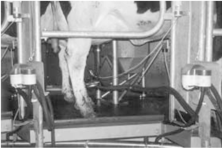
Malkepladsen med malkesæt, pulsatorstyring og automatisk aftager
