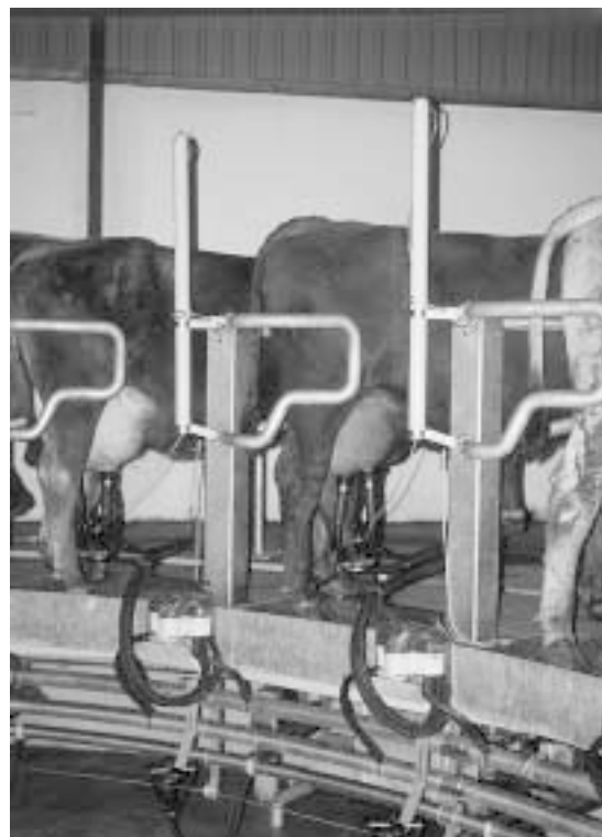
Selve malkepladsen, med malkesæt, pulsatorstyring og automatisk aftager
