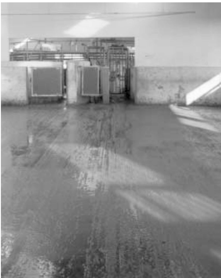
Figur 4.3 Eksempel på indgangsparti til malkekarrusel set fra opsamlingspladsen. Den har indgang midt i pladsen, men den kunne også være med indgang i den ene side af opsamlingspladsen.
