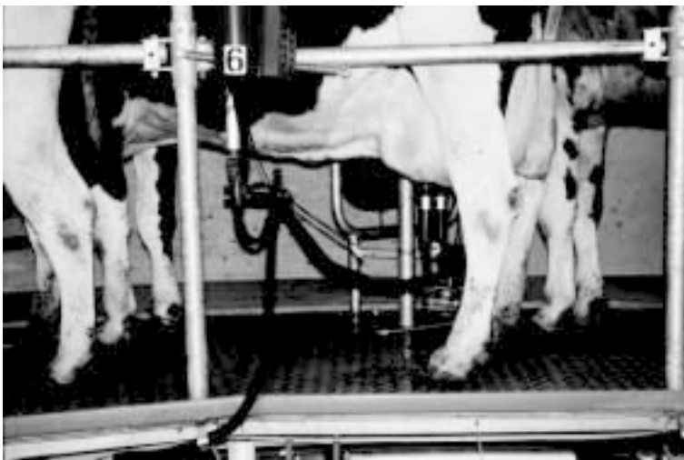
Malkesæt og slangestyr på DeLaval karrusel
