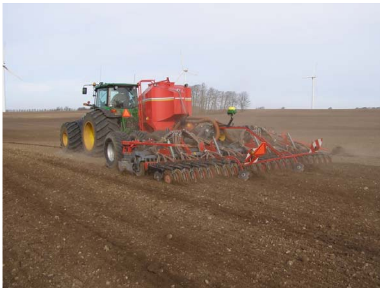
Figur 9. Horsch Pronto 6 K med dobbelte skiveskær.
