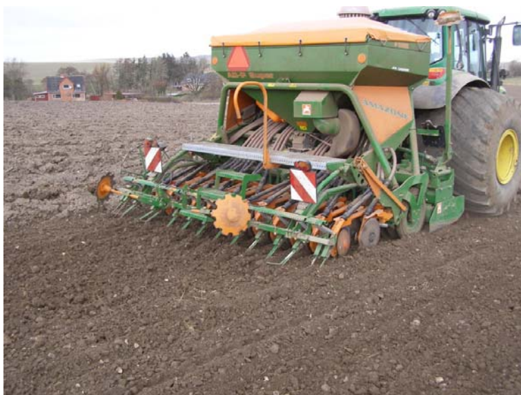
Figur 4. Amazone AD-P super har enkelte skråtstillede konvekse såskær med en afskraberskive.
