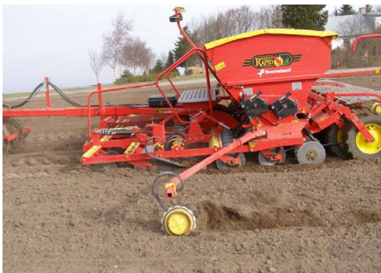
Figur 1. Väderstad Rapid med enkelte skråtstillede, flade skiveskær til både gødning og såsæd.
