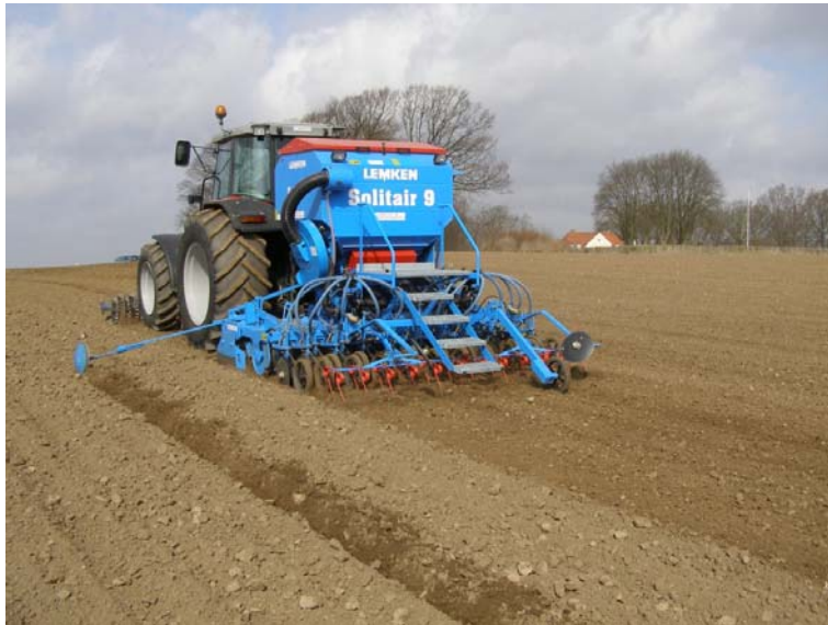
Figur 7. Lemken Solitair 9 skiveskærsåmaskine
