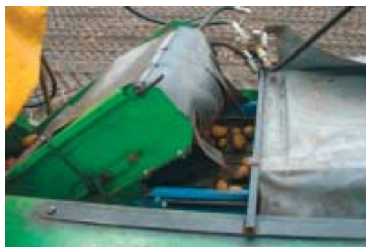
Figur 2. Et gummibånd blev placeret under tankelevatoren. Hermed sikres en ensartet faldhøjde og dermed hastighed for alle kartoffelknolde.
