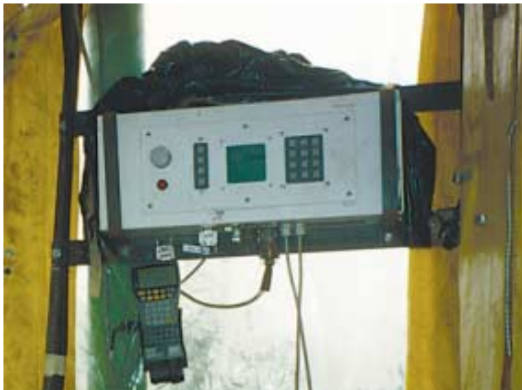
Figur 6. Målinger fra kameraet behandles i en AgriSort-computer, der tæller alle kartofler (øverst i billedet). I PSION WorkAbout-computeren derunder lagres pixelværdier fra AgriSort-computeren sammen med positioner fra DGPS-modtageren.
