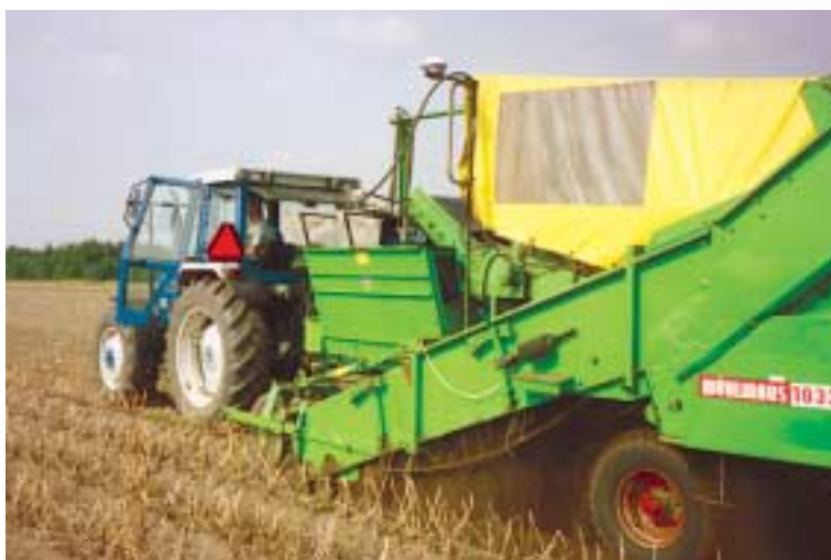
Figur 5. DGPS-modtageren var monteret over jordkæden.
