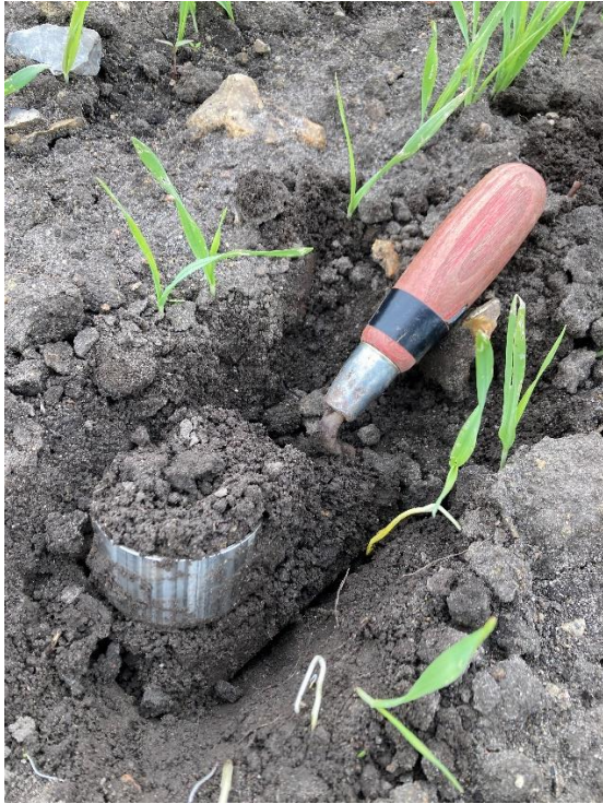
Billede 4 Med en murerske løftes ringen forsigtigt op.
