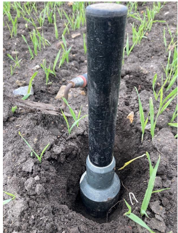
Billede 3 Ringpresser presser ringen ned, indtil jorden er et par millimeter over ringens top.
