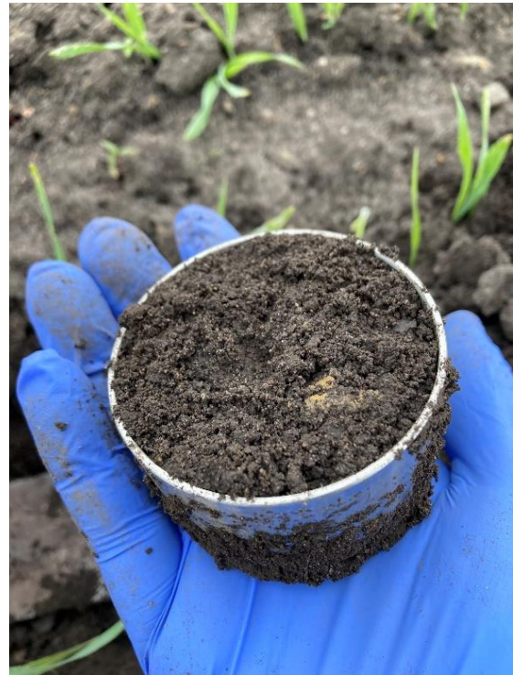
Billede 5 Skrab/skær overskydende jord væk, så der ikke stikker noget jord ud over ringens top og bund.
