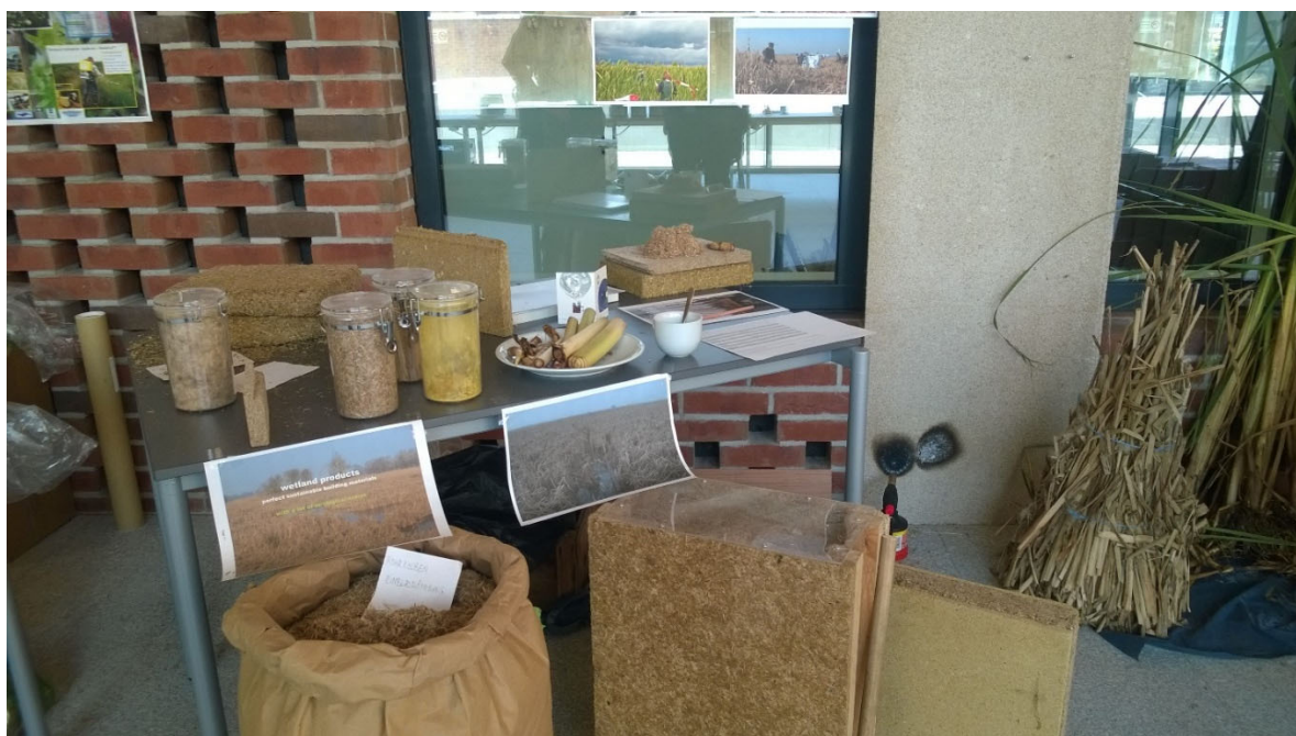
Isoleringsmateriale lavet af dunhammer i Tyskland. Foto: Frank Bondgaard, SEGES Innovation.
