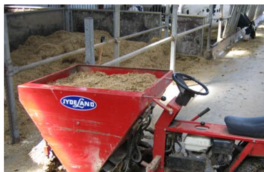
Figur 3.3 Skrabe- og strømaskine, som blev brugt til at skrabe gangarealerne og strø både spåner og snittet halm i FarmTesten.
