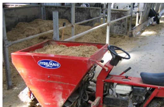
Figur 3.3 Skrabe- og strømaskine, som blev brugt til at skrabe gangarealerne og strø både spåner og snittet halm i FarmTesten.
