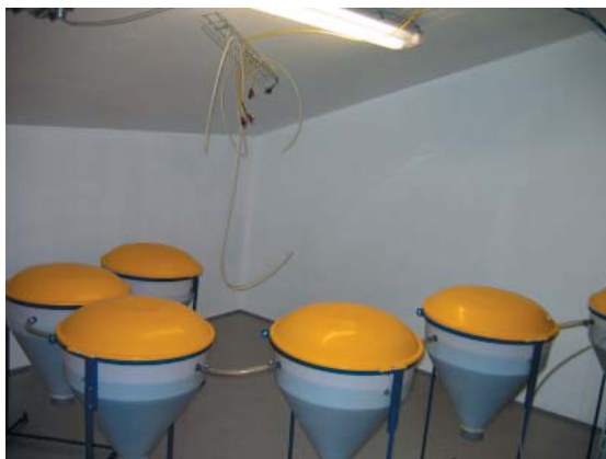
Figur 7.4. I alt indgår der fem af disse bundfældningsbeholdere i systemet. Fra sidste beholder (bagerst) løber olien ned til en stor bundfældningstank.
