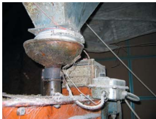
Figur 5.15 Bemærk, at varmelegemet er monteret omkring røret af frøtageren. Et termolegeme sikrer den rette temperatur.
