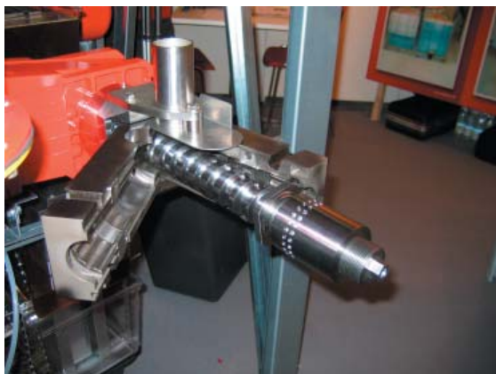
Figur 7.27. Blotlagt skrue i Hybren H30 oliepresser med booster. Bemærk sporene på den indvendige flade i svøbet (til venstre i billedet).
