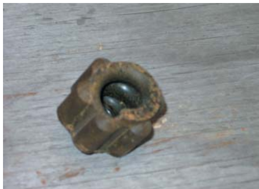
Figur 5.4 Prop fra tilstoppet pressehoved.
