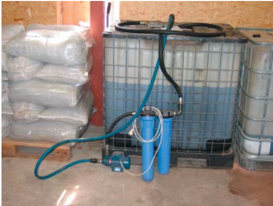
Figur 7.15. Filtersystem til filtrering af rapsolie på ejendom nr. 5. De viste filtre er oprindeligt konstrueret til rensning af drikkevand for okker. Filtrene er forbundet.
