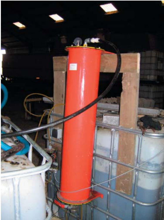
Figur 7.13. Søjlefilter til filtrering af olie. Søjlefilteret kan monteres på en væg, en palletank som vist, eller andet.
