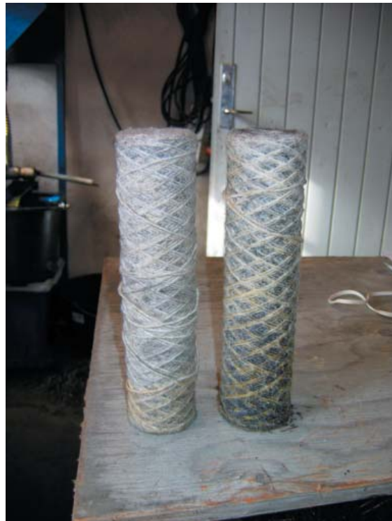
Figur 7.18. Brugte garnnøgle-filterindsatser fra filteret på billedet til højre.
