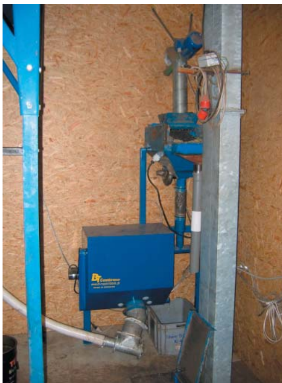
Figur 7.26. Frøene renses i rysterenseren (øverst) og løber så ned i den lille blå kasse nedenunder. Herfra transporteres de med en flexsnegl op i en stor forsilo, under hvilken oliepresseren befinder sig.
