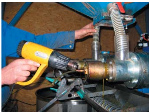
Figur 5.3 Opvarmning af pressehoved forud for igangsætning af presning.
