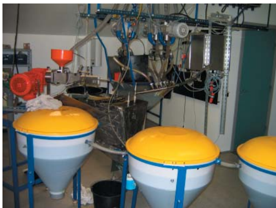
Figur 7.3. Bundfældningsbeholdere til oliepresning på ejendom 5. Beholderne er forbundne, og olien løber fra den ene beholder til den næste. Oliens opholdstid i hver beholder er relativt kort.
