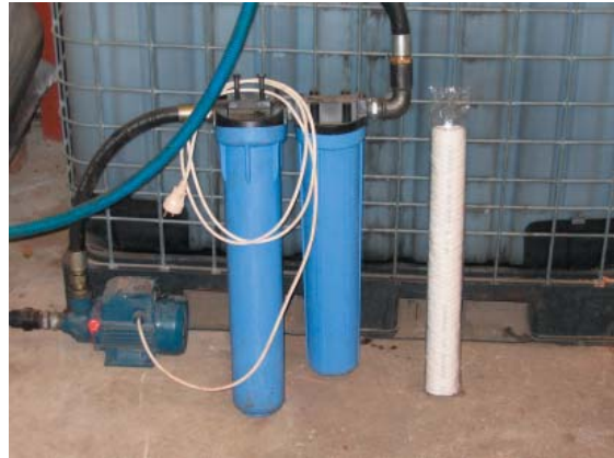
Figur 7.16. Til højre for filtrene ses en ny filterindsats. Den består af et garnnøgle. Filtreringsgraden er 1 my.
