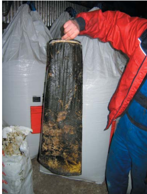
Figur 7.14. Filterpose-indsats fra søjlefilteret på billedet til venstre. Smudset sidder udvendigt på filterposen, da olien trykkes udefra og ind gennem posen. Posen understøttes indvendigt.
