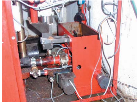
Figur 8.3. Den integrerede oliepresser i fyret. Øverst i billedet ses presseenheden; derunder selve stokeren, som fører rapskagen til fyret, som kan anes til venstre.
