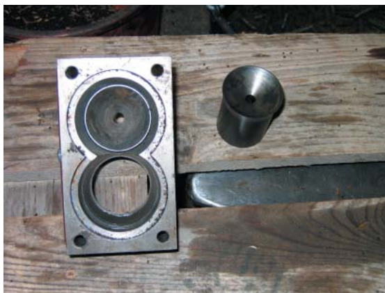
Figur 7.28. Dele fra pressehoved fra SWEA PP lagt på en euro-palle. Bemærk det svære gods. Diameteren af selve hullet i de massive pressecylindre er 8 mm.
