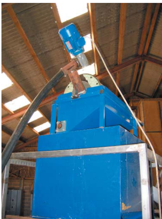
Figur 7.25. Flexsnegl fører de urensede frø op til tromlensereren. Herfra falder de rensede frø ned i den blå kasse nedenunder og herfra videre ned til oliepresseren (uden for billedet).
